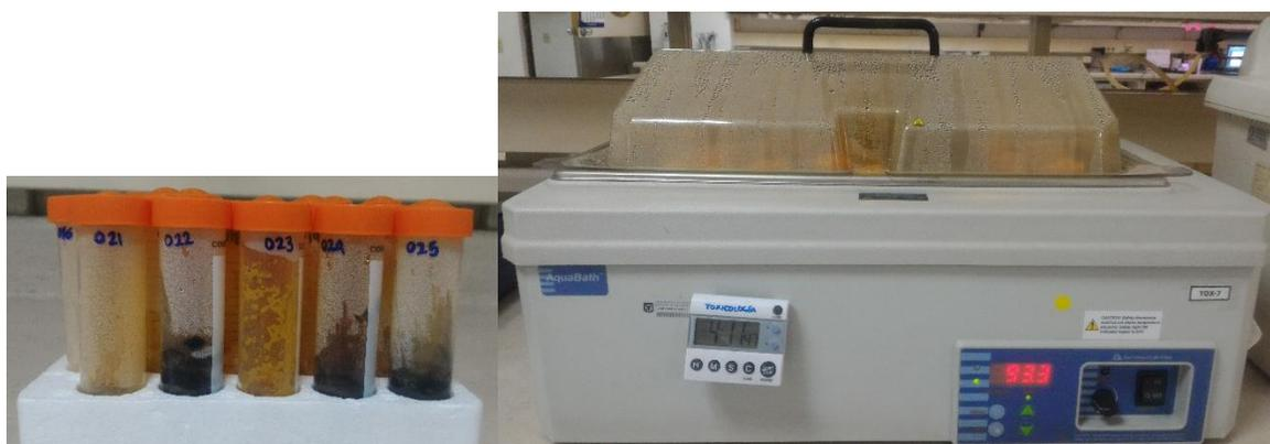
**Figura 3-9.** Digestión ácida asistida por calor de las muestras.
