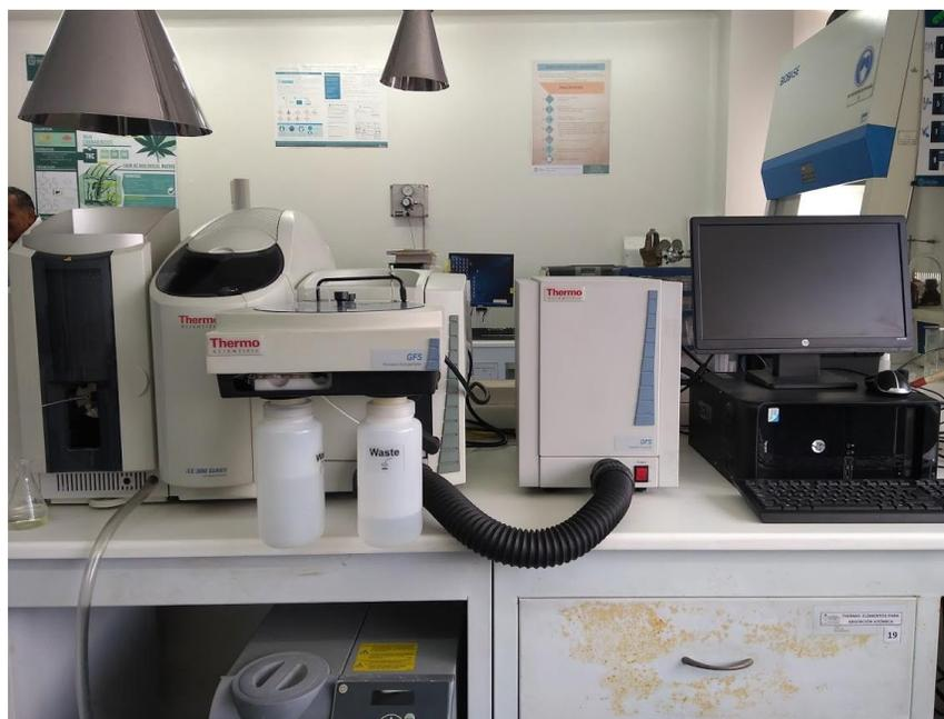
**Figura 3-4.** Fotografía del Espectrofotómetro de Absorción Atómica con Horno de Grafito Modelo ICE 3500 de Thermo.
