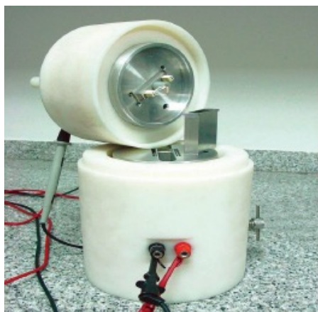
Figura 2 - 8. Calorímetro de Conducción de Calor Tipo Calvet.
