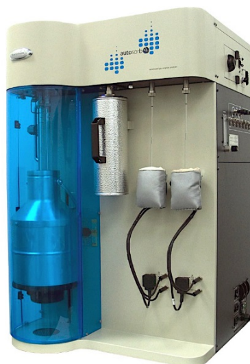
Figura 2 - 9. Equipo para la determinación de Isotermas de adsorción de CO 2
