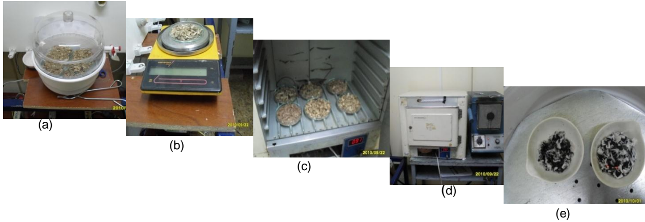
Figura 15. Proceso de determinación del contenido de volátiles de las muestras de leña (a) conservación de la muestra sin absorber humedad del ambiente, (b) pesado de la muestra, (c) introducción de las muestras al horno (d) mantenimiento de las muestras en él durante 6 minutos, (e) estado final de las muestras a su salida del horno.
