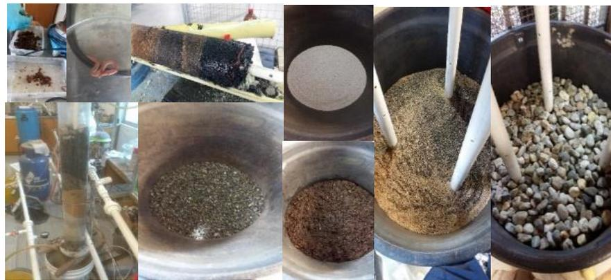
Figura 24. Reactor donde se realizó el proceso de Vermifiltración a escala laboratorio. Fuente: Elaboración propia.
