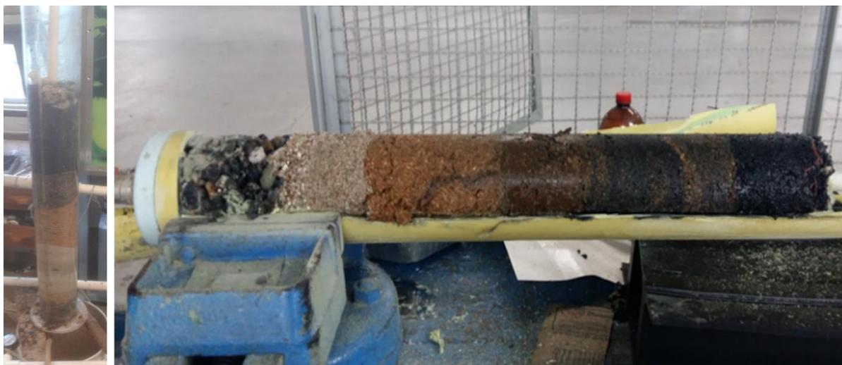
Figura 16. Sistema de Vermifiltración a escala de laboratorio de 4" de Diámetro Nominal. Fuente: Elaboración propia.
