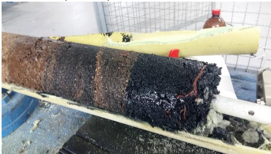
Figura 17. Foto interna del Vermifiltro donde se aprecian las capas. Fuente: Elaboración propia.
