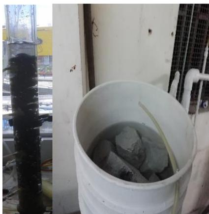
Figura 25. Reactor donde se realizó el proceso de acondicionamiento de pH. Fuente: Elaboración propia.
