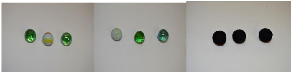
Figura 42. Perlas de vidrio, limpias, con resina y con el carbón activado fijo en su superficie. Fuente: Elaboración propia.
