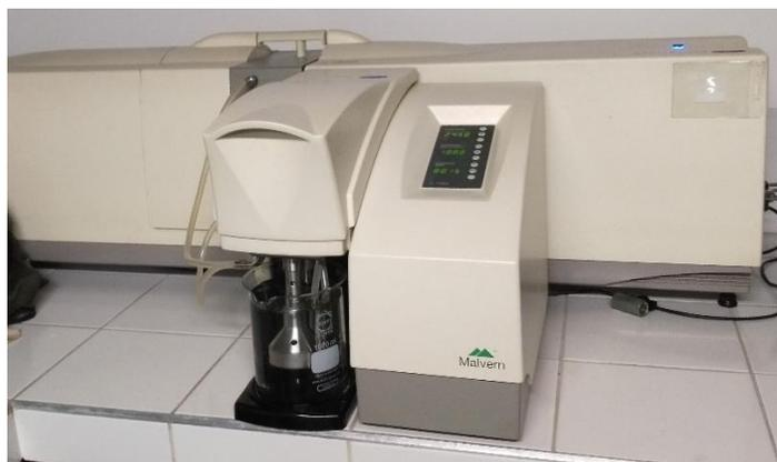
**Figura 22:** Fotografía del equipo de granulometría láser utilizado en el estudio.
