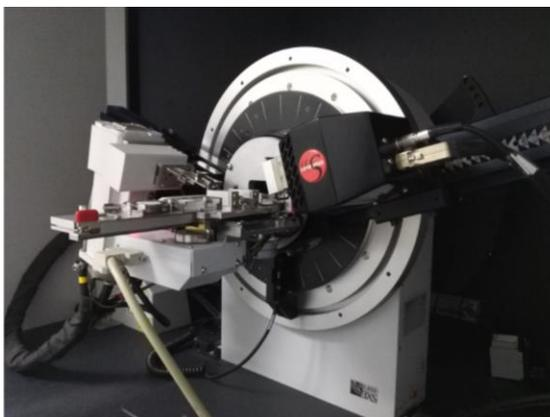
**Figura 25:** Fotografía del difractómetro de rayos X utilizado en la investigación.
