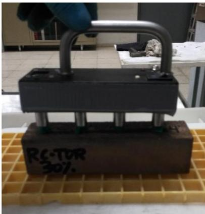
**Figura 29:** Resistivímetro empleado en el estudio.
