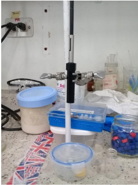
Figura IA2.5 Montaje de microextracción en fase sólida (SPME-HS)
