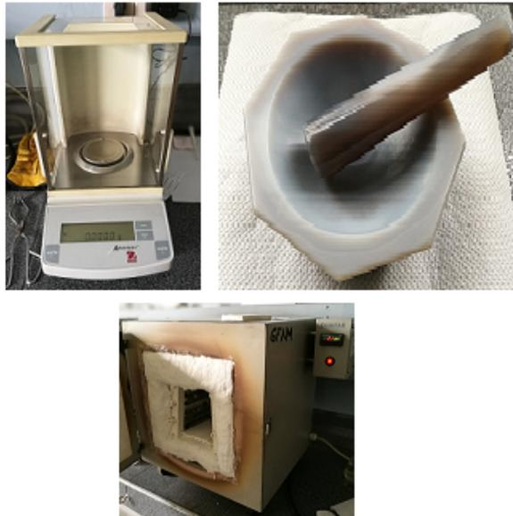
**Figura 3-1.:** Procedimiento del método de reacción de estado sólido.
