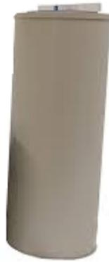
Figura 9.9: Imagen de la Cámara de ionización del activímetro del Capintec CRC55tR,
