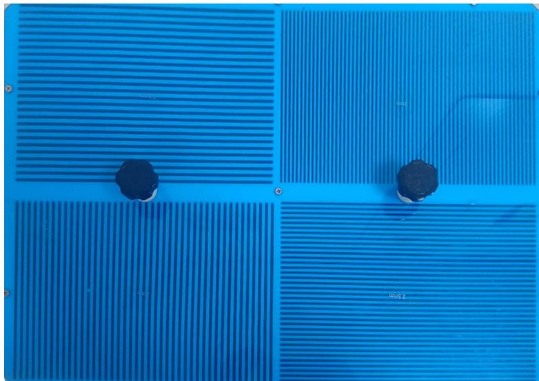
Figura 7.5: Simulador físico de barras de cuatro cuadrantes. En la parte inferior izquierda las barras son de 2 mm, superior izquierda de 2.5 mm, superior derecha de 3 mm e inferior derecha 3.5 mm
