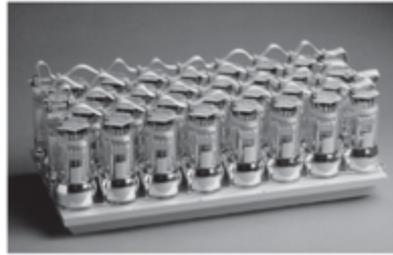
Figura 5.8: Tubos fotomultiplicadores en un detector rectangular de una gammacamara sobre un cristal Na(TI). [14].
