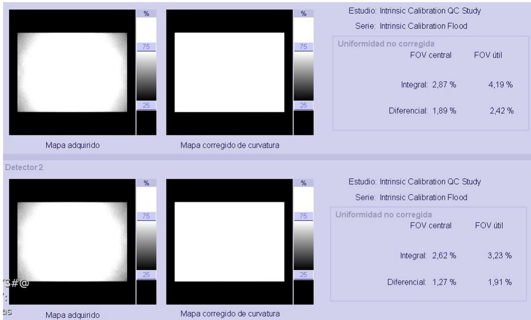
Figura 10.3: Mapa de uniformidades obtenido después del mantenimiento correctivo en la gammacámara Symbia, con valores de referencia < 2.94 % para la uniformidad integral en CFOV y para UFOV <3.74 % .
