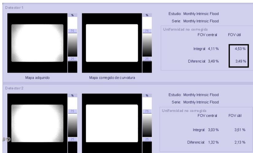
Figura 10.12: Mapa de uniformidades obtenido después de la limpieza de la contaminación del detector 1 de la gammacámara E.Cam.
