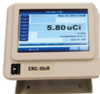
Figura 9.8: Modelo del Activímetro Capintec 55tR, utilizado en la IPS
