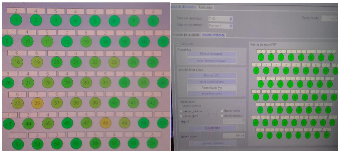
Figura 10.8: La imagen muestra un ejemplo del tune en el software E. Soft. Cada círculo identifica los 59 tubos fotomultiplicadores de la gammacámara, estos cambian de color verde, si son adecuados; amarillo si presentan degradación o rojo si están fuera del intervalo de aceptación en ganancia o en alto voltaje. . Derecha Ventana del tune de la gammacámara Symbia
