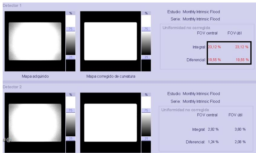
Figura 10.10: Mapa de uniformidades no corregido de la gammacámara E.cam por contaminación en el detector 1. Valores de CFOV integral de 23.12 % y CFOV diferencial de 19.55 % fuera del rango aceptado.
