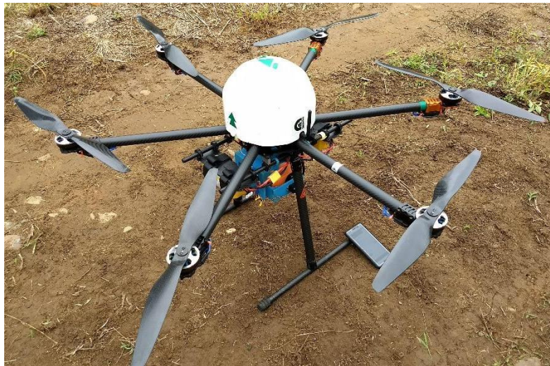
Figura 2-4: RPAS "CERES", hexacóptero utilizado para la toma de las imágenes.
