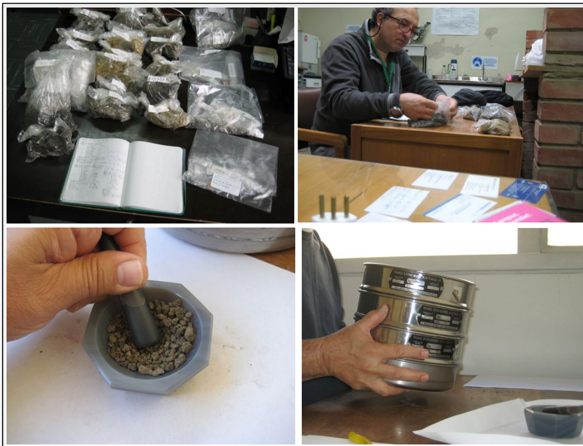
Figura 4-4: Los sedimentos circundantes de los materiales arqueológicos se preparan - moliendo y tamizando - para la determinación de radioisótopos naturales para la cuantificación de Uranio ( ^{238}\text{U} ), Torio ( ^{232}\text{Th} ) y Potasio ( ^{40}\text{K} ).
