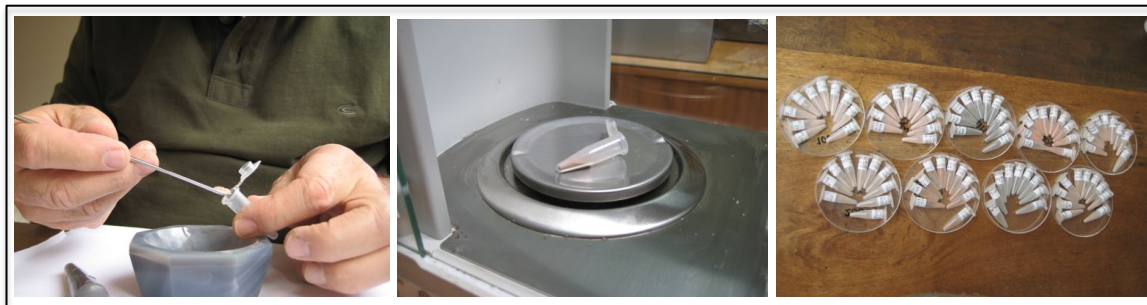
Figura 4-7: La preparación de las muestras de cerámica para la irradiación artificial.
