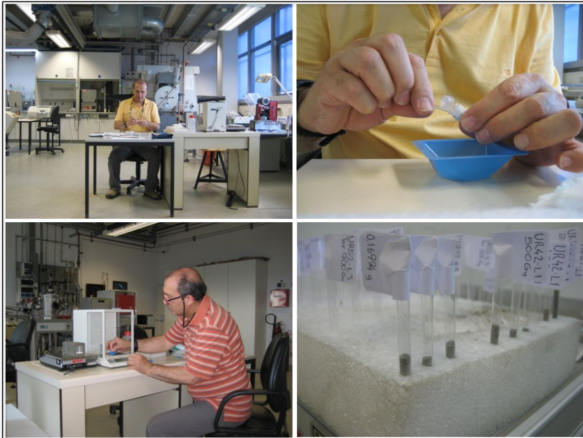
Figura 4-10: Preparación de las muestras para las medidas con EPR en el Laboratorio de Probenvorbereitung, en el Instituto de Física de la Universidad de Augsburg, Alemania.
