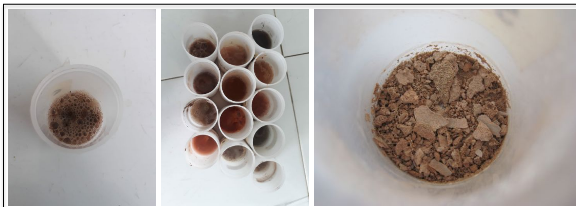
Figura 4-5: El lavado de las muestras de cerámica en polvo con H_2O_2 .
