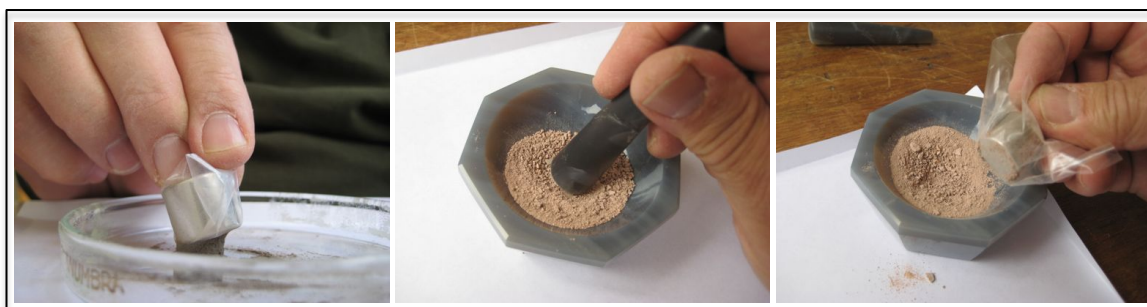
Figura 4-6: El proceso de separación magnética, usado para limpiar los materiales magnéticos en las muestras de cerámicas en polvo, con la ayuda de un imán.
