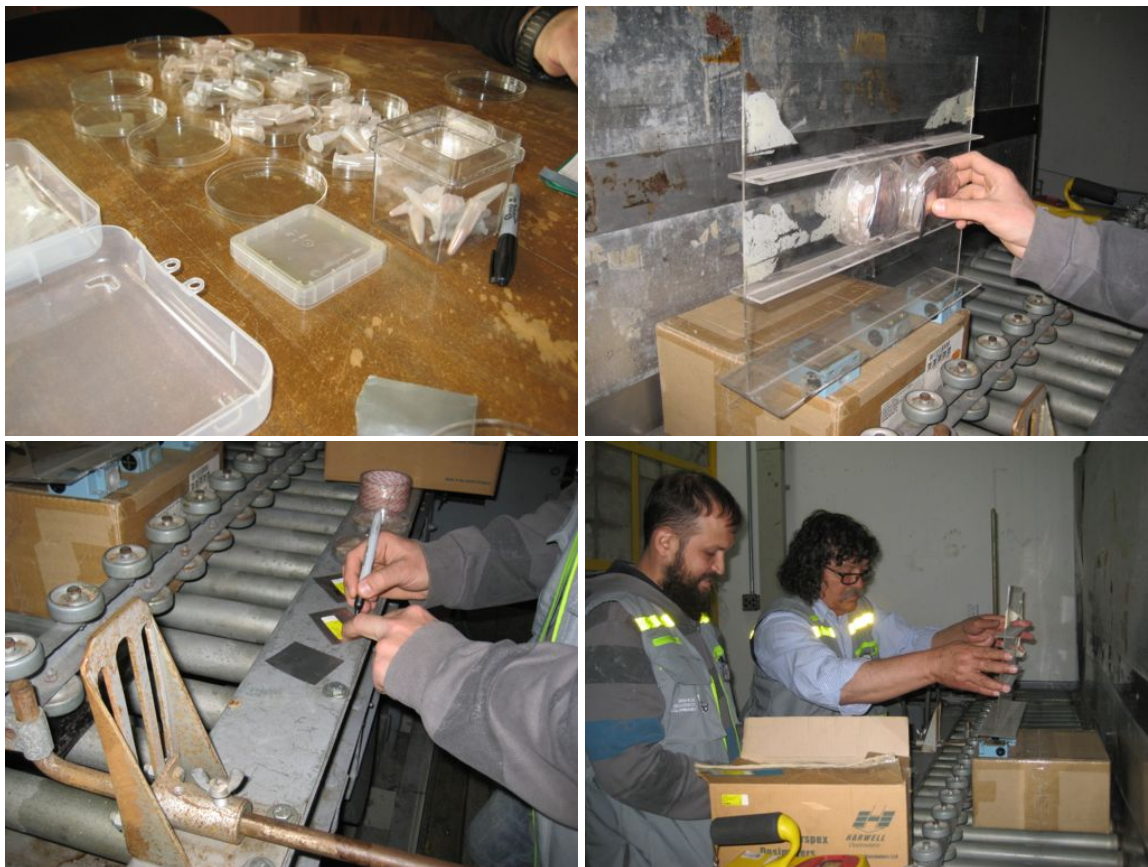
Figura 4-8: La preparación de las muestras de cerámica para la irradiación artificial en el Instituto de Minas y Energía del Servicio Geológico Colombiano en Bogotá.
