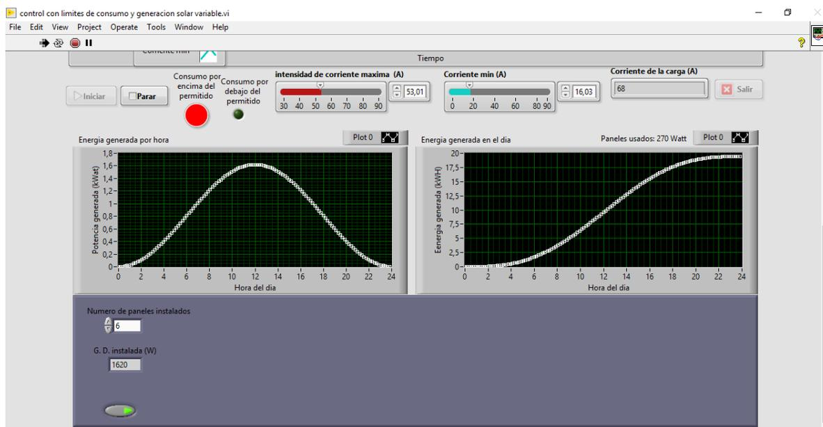
Figura 4-14. Registro del sistema de generación solar fotovoltaico de la interfaz del operador del programa control en LabVIEW®. Fuente. Elaboración Propia.
