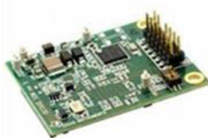
Figura D-4. Módulo SOM. Fuente: Texas Instruments.
