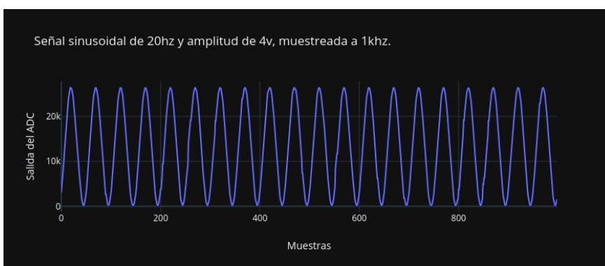
Figura 3-12.: Señal sinusoidal, frecuencia 20hz, amplitud 4v, muestreo a 1khz.
