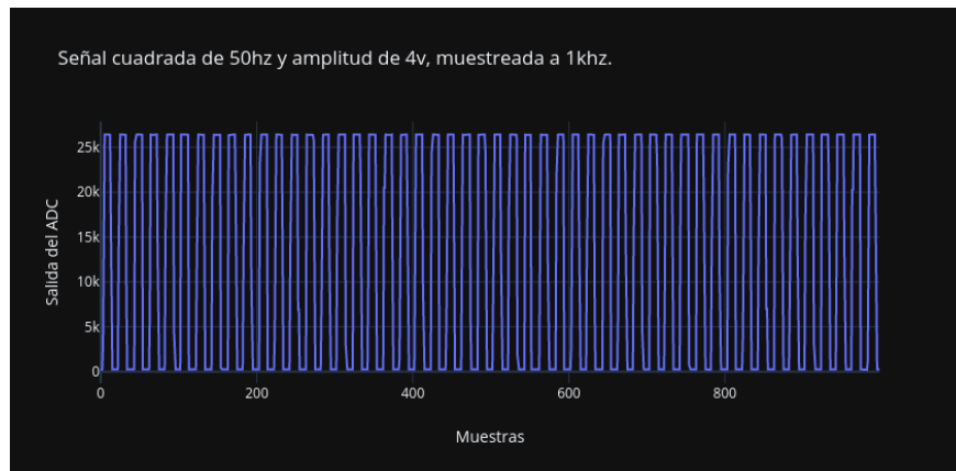
Figura 3-14.: Señal cuadrada, frecuencia 50hz, amplitud 4v, muestreo a 1khz.
