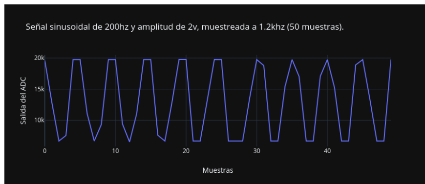
Figura 3-19.: 50 muestras de una señal sinusoidal, frecuencia 200hz, amplitud 2v, muestreo a 1.2khz.
