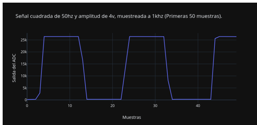
Figura 3-15.: 50 muestras de una señal cuadrada, frecuencia 50hz, amplitud 4v, muestreo a 1khz.
