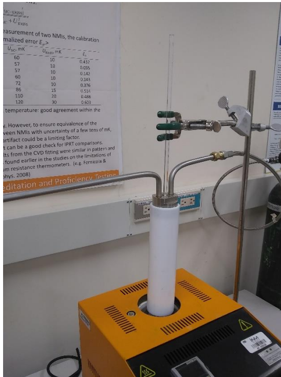
Figura 3-7: Inserción de termo-pozo
