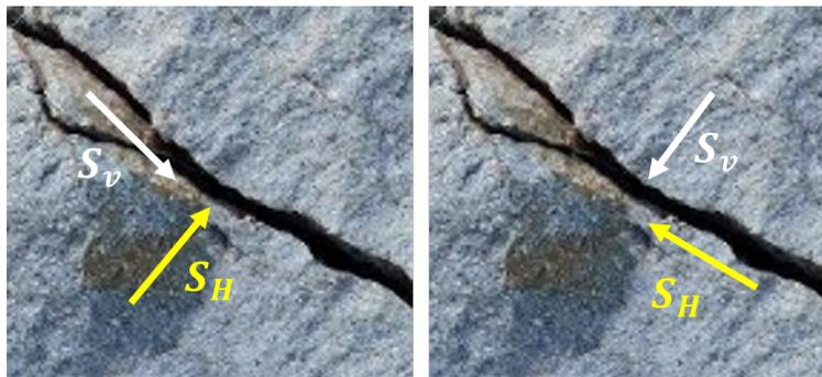
**Figura 2-5:** Representación del efecto de la dirección de los esfuerzos sobre una fractura.
