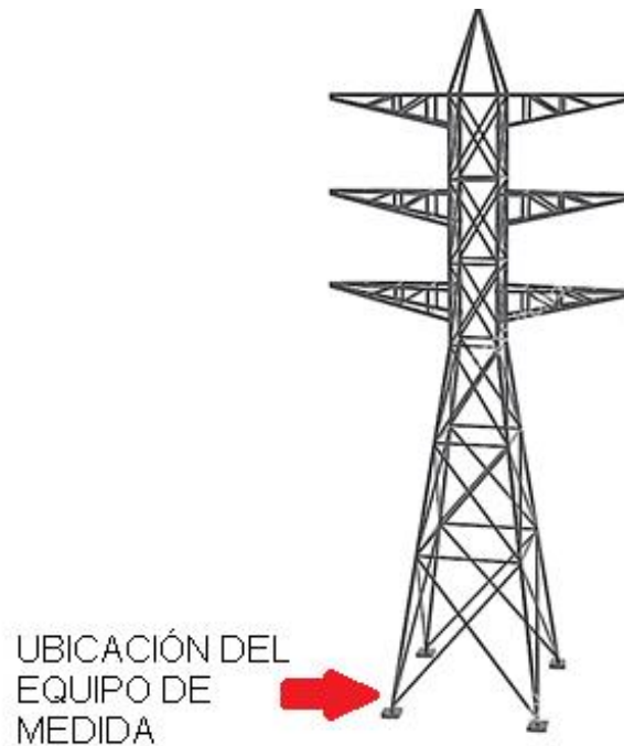
Figura 184. Ubicación del equipo de medida en la torre de transmisión
