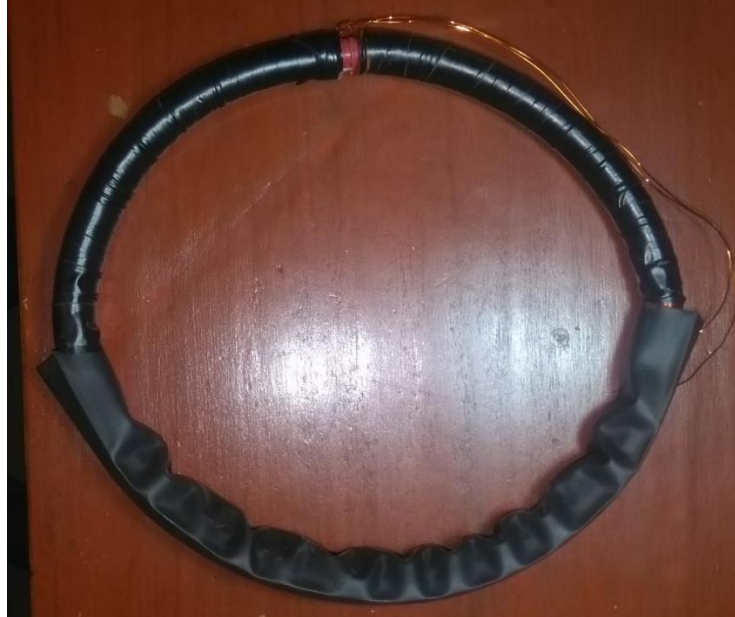
Figura 206. Tercera bobina de Rogowski construida
