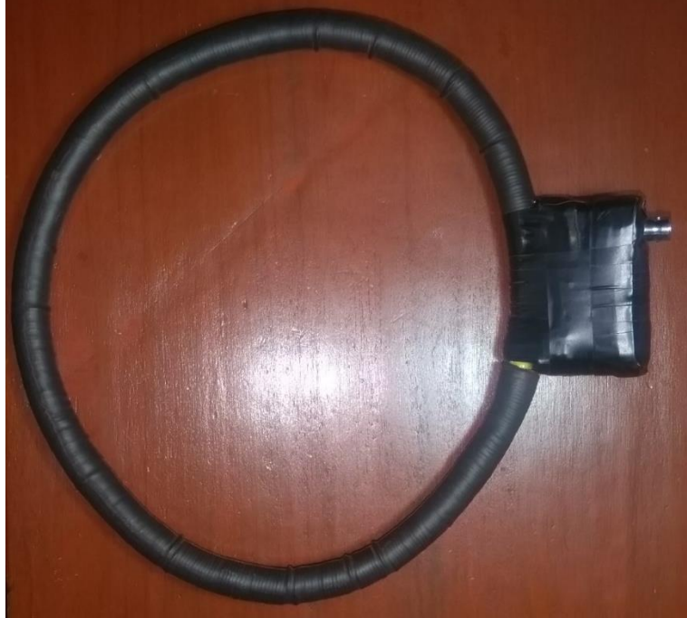
Figura 204. Segunda Bobina de Rogowski construida
