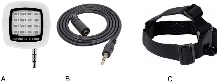
Figura 6. (A) Imagen de fuente de luz led con grilla de 16 bombillos, batería recargable y entrada tipo AUX 3.5 mms la cual se adapta a (B) una extensión de 1.5 metros y permite controlar el inicio y la duración del estímulo lumínico de manera remota. Estos elementos se acoplan sobre (C) un arnés ajustable alrededor de la cabeza que permite mantener la orientación y la distancia del estímulo lumínico a 2 centímetros del ojo a estimular.
