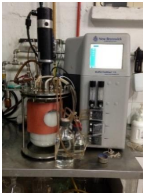
Fotografía 1. BioFlo/CellGen 7L para ensayos de estimación de fases de crecimiento celular.
