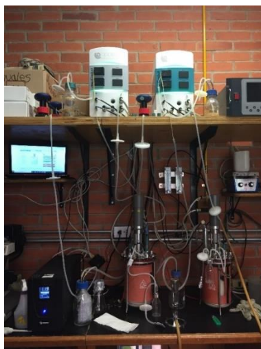
Fotografía 3. Reactores Applikon en línea de 3 L para corridas de ajuste del modelo.
