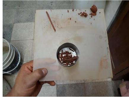
Figura 3.6 Determinación del límite plástico
