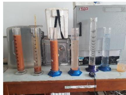
Figura 3.4 Granulometría por Hidrómetro
