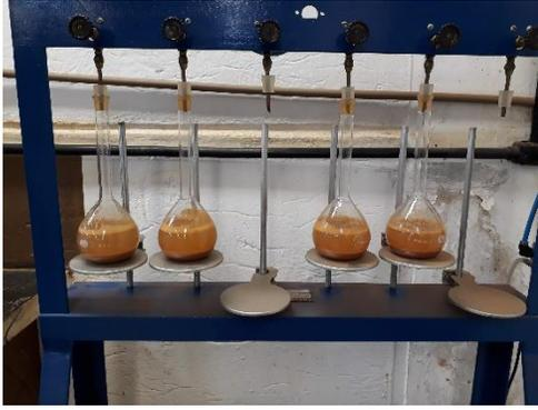
Figura 3.1 Método de Picnómetro de fondo Plano
