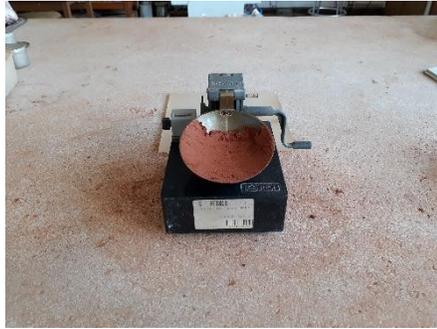
Figura 3.5 determinación del Límite Líquido
