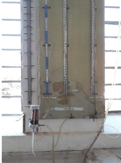
Figura 3.20 Ensayo de carga constante
