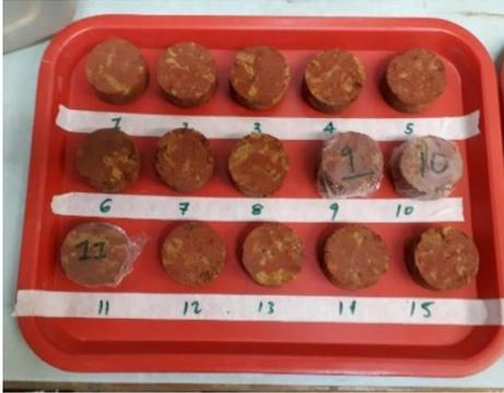
Figura 3.16 Secado de especímenes
