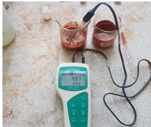
Figura 3.9 medición del pH en KCl y agua
