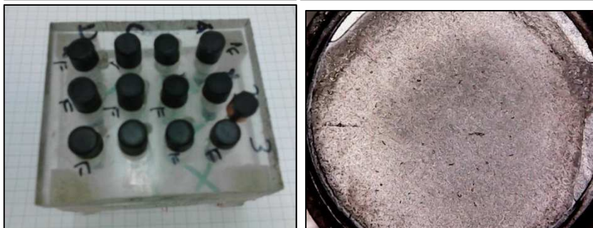
Figura 36. Proceso de fabricación de electrodos con recubrimiento nanocomposito polímero-metal.
