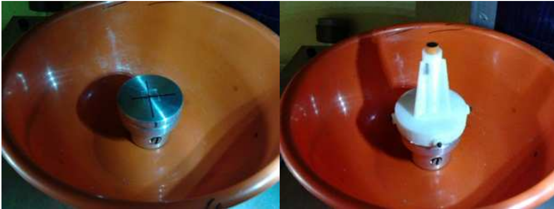
Figura 37. Sistema spin coating para diferentes sustratos; izquierda: silicio, derecha: electrodos de grafito.
