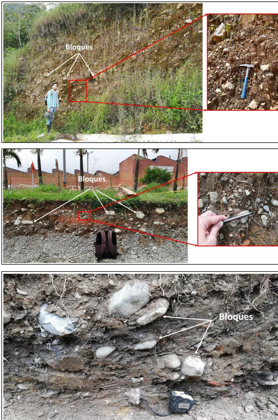
Figura 2-8. Ejemplos de bimsoils de diferentes orígenes. Depósito coluvial en San Andrés de Cuerquia – Antioquia (Arriba), depósito aluvial del río Medellín a la altura de Envigado - Antioquia (Intermedia) y lleno antrópico en la Avenida Regional a la altura de Envigado – Antioquia (Abajo). Elaboración propia.
