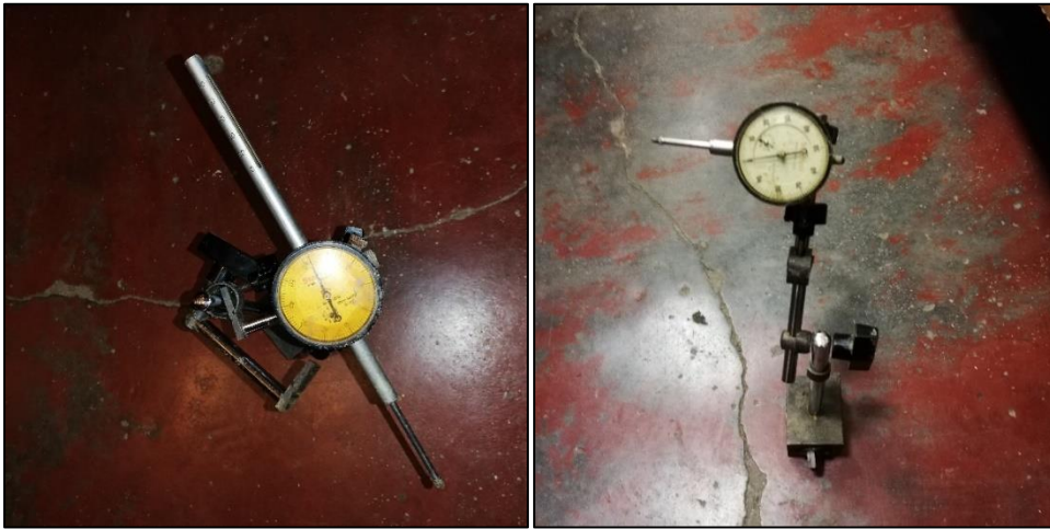
Figura 3-15. Extensómetro para medición de desplazamientos. Elaboración propia.
