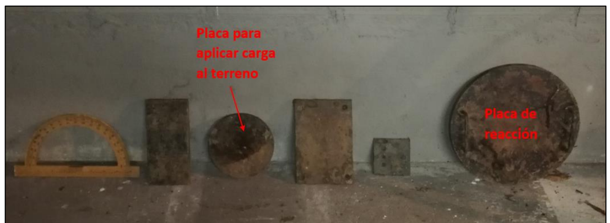
Figura 3-14. Placas en acero para aplicación de carga y reacción. Elaboración propia.
