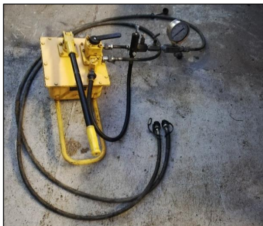
Figura 3-11. Bomba y mangueras de alta presión para accionar cilindro hidráulico para realización de ensayo HCT. Elaboración propia.
