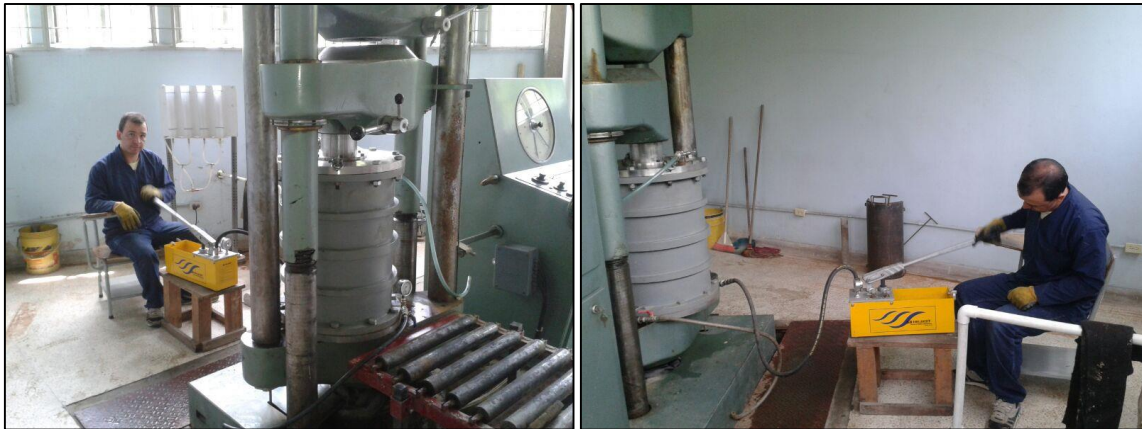
Figura 3-3. Equipo triaxial de gran dimensión usado para los ensayos de las Fuentes 4, 7 y 8.
