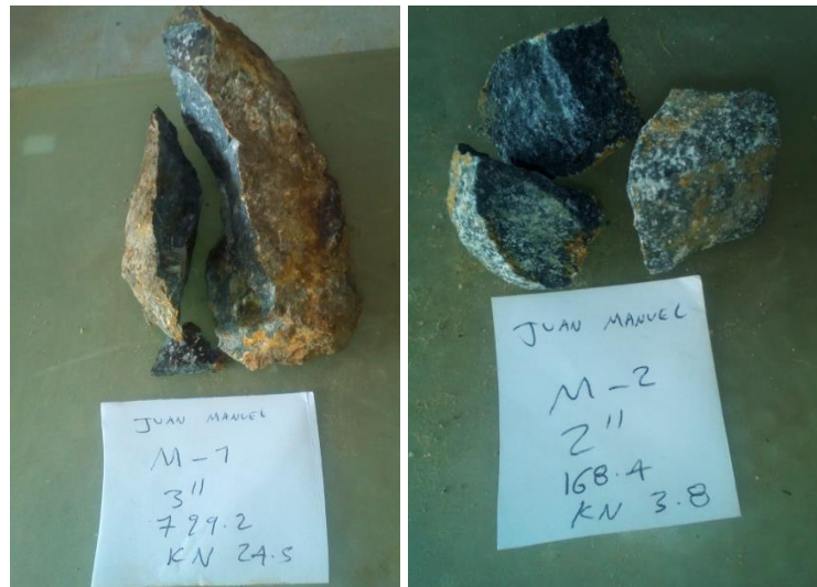
Figura 4-75. Bloques fallados en prueba de carga puntual – Finca Las Mercedes. Muestra N°1 (izquierda) y Muestra N°2 (derecha). Elaboración propia.
