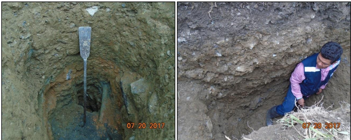
Figura 2-6. Ejemplos de Lleno antrópico con mezclas de bloques de roca y suelo. Zodme El Tejar (Izquierda) y Zodme La Redonda (Derecha). Vía San Andrés de Cuerquia – Ituango. Elaboración propia.
