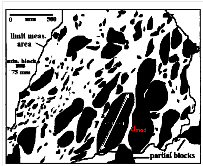
Figura 2-10. Bloques de un melange en la playa de Caspar. Se observa el d_{mod} , el cual sólo se mide de bloques completos Modificado de (Medley & Lindquist, 1995).
