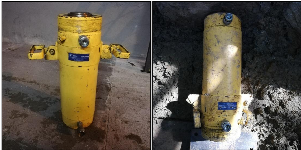
Figura 3-10. Cilindro hidráulico marca ENERPAC para realización de ensayo HCT. Elaboración propia.
