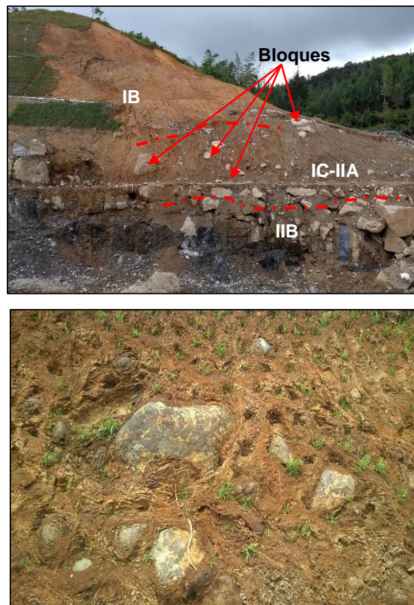
Figura 2-5. Ejemplos de perfil de suelo tropical con intercalaciones de bloques de roca y suelo. Perfil de meteorización de (Deere & Patton, 1971) del Batolito antioqueño en El Peñol – Antioquia (Arriba) y meteorización esferoidal en Tarso – Antioquia (Abajo). Elaboración propia.
