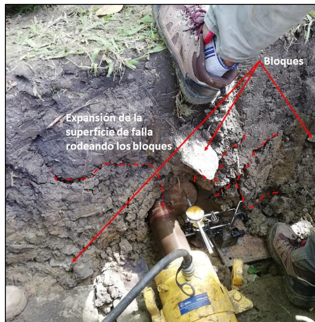
Figura 4-64. Evidencia de la tortuosidad de la superficie de falla – E1 – Finca Las Mercedes. Elaboración propia.
