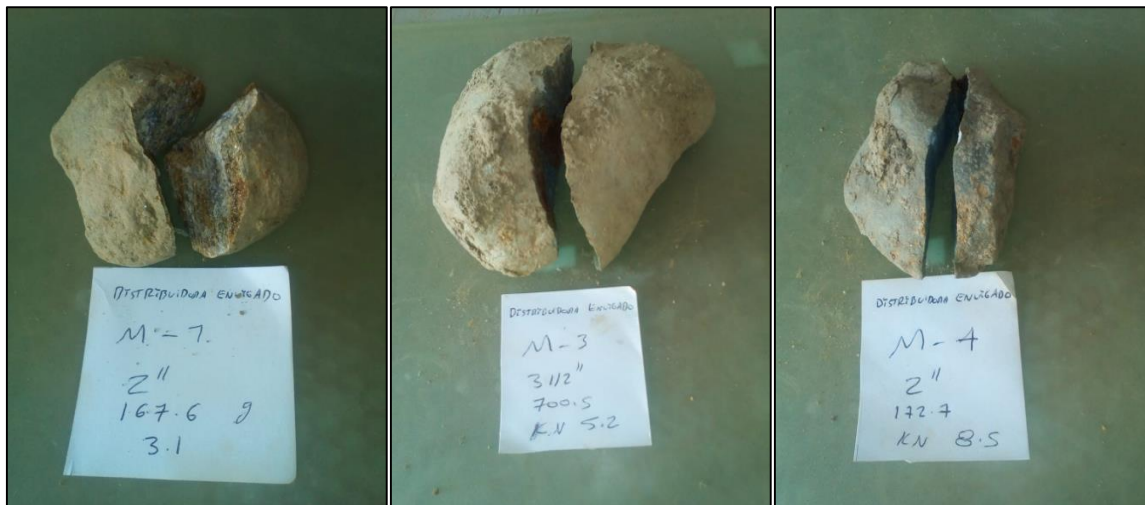
Figura 4-70. Bloques fallados en prueba de carga puntal – Distribuidora de Envigado. Muestra N°1 (izquierda), Muestra N°2 (intermedio) y Muestra N°3 (derecha). Elaboración propia.
