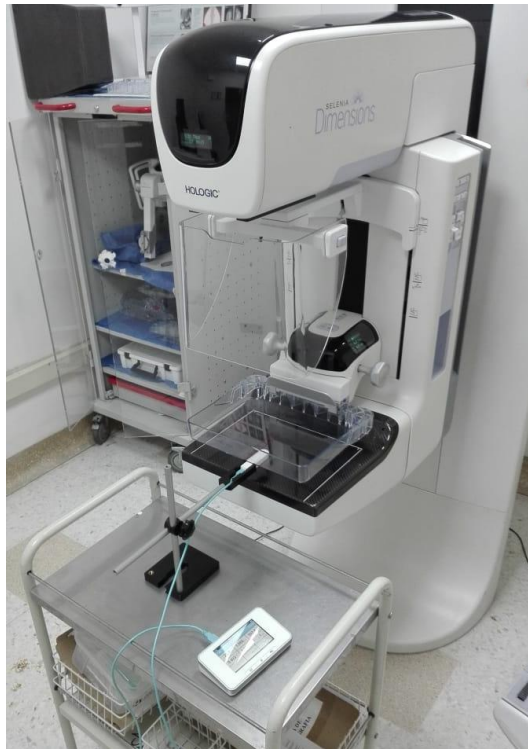
Figura 2-5: Montaje para la prueba de exactitud y repetibilidad de la tensión.
