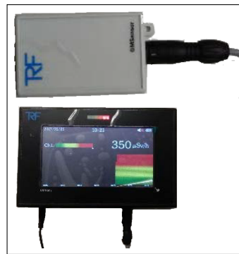
(c) GM Rady TRF ( Superior: Sonda externa; Inferior: Sonda interna ). Tomado de [36]
