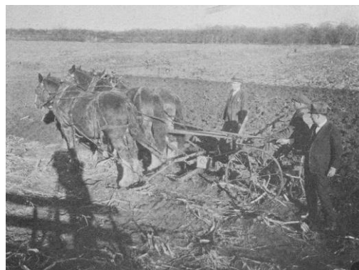
Figura 3-4: “Dinamómetro Integrador de Tracción Animal - Iowa” acoplado a un implemento agrícola
