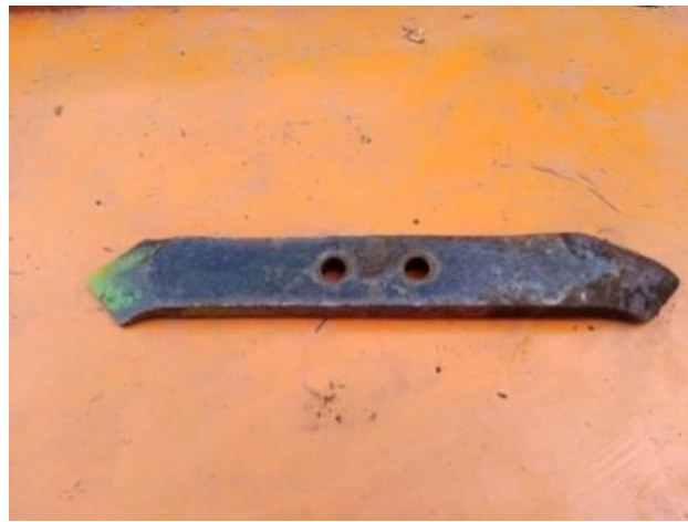
Figura 5-9: Herramienta de cincel para “romper” o roturar el suelo
