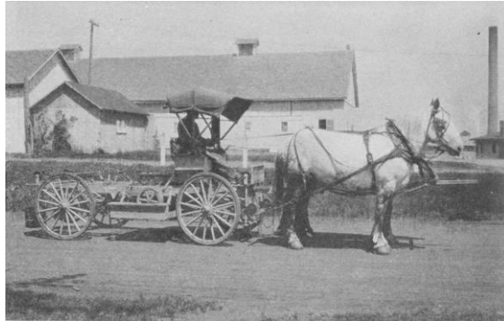
Figura 3-1: Dinamómetro pequeño para medir la fuerza de tiro de dos animales con cargas normales
