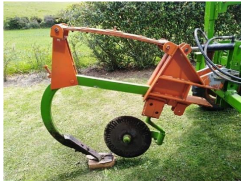
Figura 5-16: Cincel parabólico con disco de corte y servo hidráulico.
