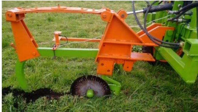
Figura 5-6: Sensor de distancia montado en el cincel parabólico a profundidad máxima de trabajo.
