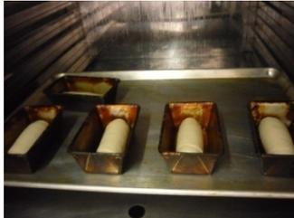
Se lleva al cuarto de fermentación el cual tiene una humedad relativa  $>80\%$  y una temperatura de aproximadamente  $30^{\circ}\text{C}$  para que la levadura cumpla su función de fermentar la masa a estas condiciones ideales para su buen desarrollo y crecimiento de la masa de acuerdo a la producción de gas  $\text{CO}_2$  producto del proceso fermentativo.
