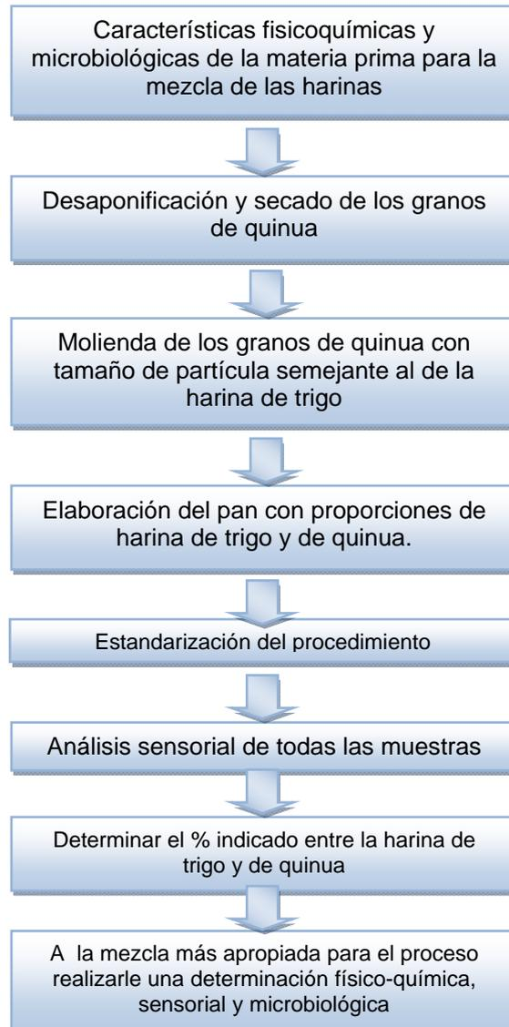
Inicialmente se determinan las características fisicoquímicas y microbiológicas de las materias primas que conforman la mezcla de harinas (el grano de quinua y la harina de trigo) con los análisis de laboratorio identificados en la tabla 3 para poder realizar una comparación del aporte nutricional adicional que le da la quinua con respecto al producto testigo.
