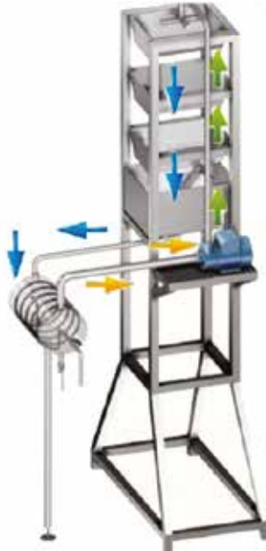
Figura 62. Diagrama recirculación del agua torre de enfriamiento.
