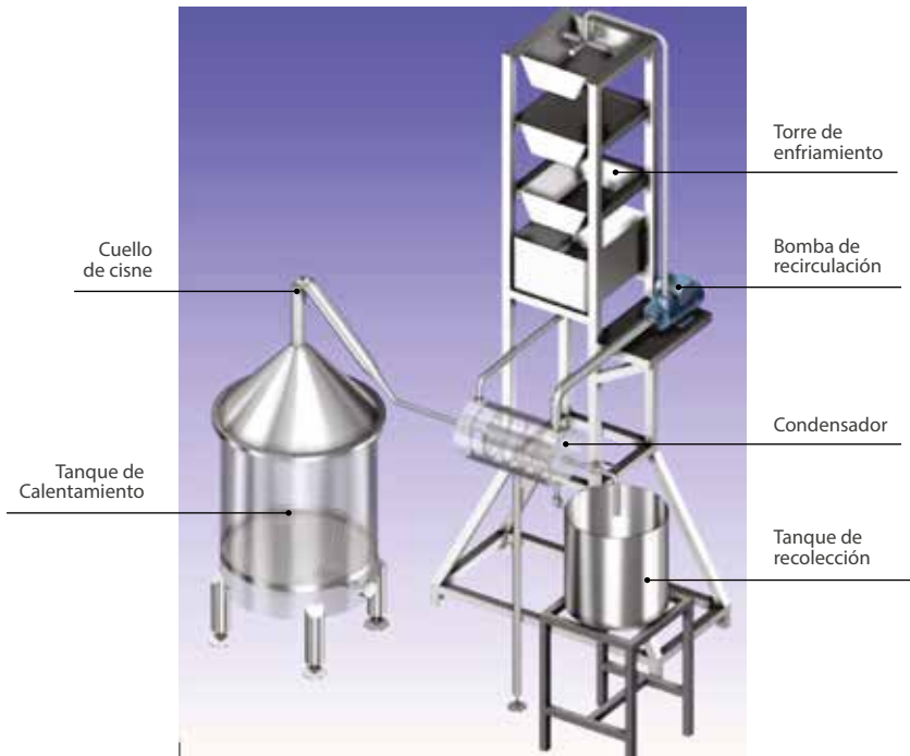
Figura 60. Diagrama equipo extracción de aceites esenciales
