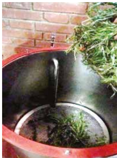
Figura 66. Llenado tanque con romero seco
