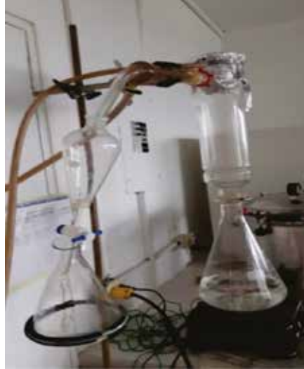
Figura 73. Destilación simple del hidrolato
