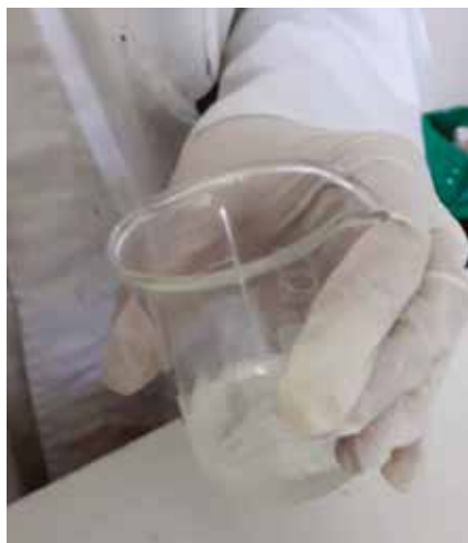
Figura 76. Agitación de la muestra de aceite con sulfato de sodio anhidro
