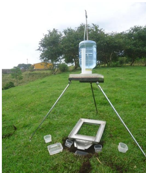
Figura 5. Mini-simulador de lluvia modelo CIAT.
