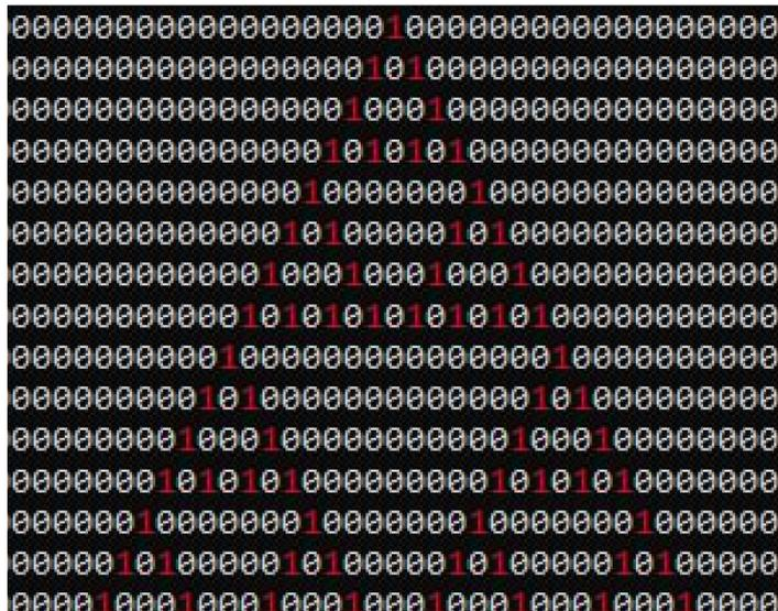
Figura 3.3 Ejemplo de un autómata celular AC unidimensional "triángulo de Sierpiński" [58].
