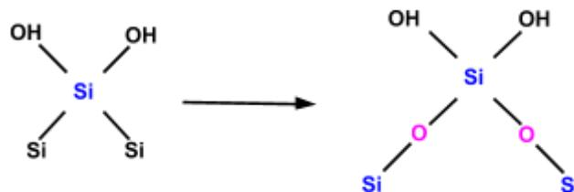
Figura 4.21 Formación de óxido en la superficie de c-Si.
