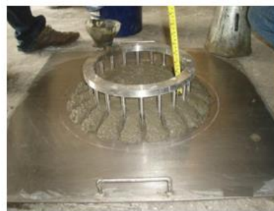
(b) Fotografía del Ensayo de Extensión con Anillo.
