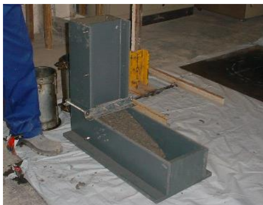
Fotografía 4.5 Ensayo de Caja en L. (De La Cruz, 2006)
