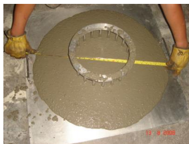
Fotografía. 4.2 Anillo de barras y Ensayo de Extensión con Anillo.
