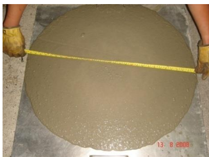
Fotografía. 3.1 Ensayo de Esgurrimiento para el HAC-RM. (LABEST)
