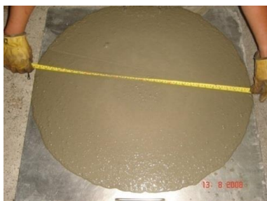
Fotografía. 4.1 Ensayo de Extensión de Flujo ó Ecurrimiento.
