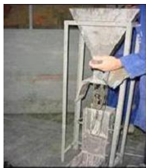
Fotografía. 3.2 Ensayo del Embudo V para la caracterización del HAC-RM en estado fresco. (De La Cruz, 2006)
