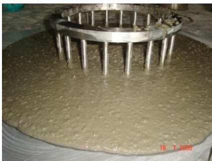
Fotografía. 3.3 Ensayo del Extensión con anillo para la caracterización del HAC-RM en estado fresco. (LABEST)
