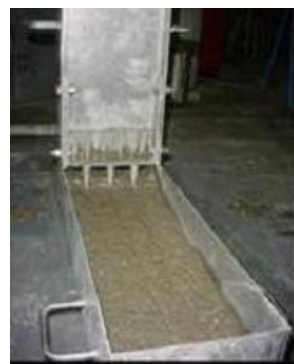
Fotografía. 3.4 Ensayo del Caja en L para la caracterización del HAC-RM en estado fresco. (De La Cruz, 2006)
