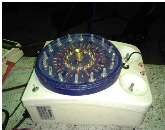
Fotografía 11. Artefacto bendeado por Carlos y usado en un concierto con su grupo Mugre en Bogotá, 2015. La ubicación de los dispositivos de interacción (como potenciómetros e interruptores) permite la ejecución de los «gestos sencillos». Fotografía del autor.
