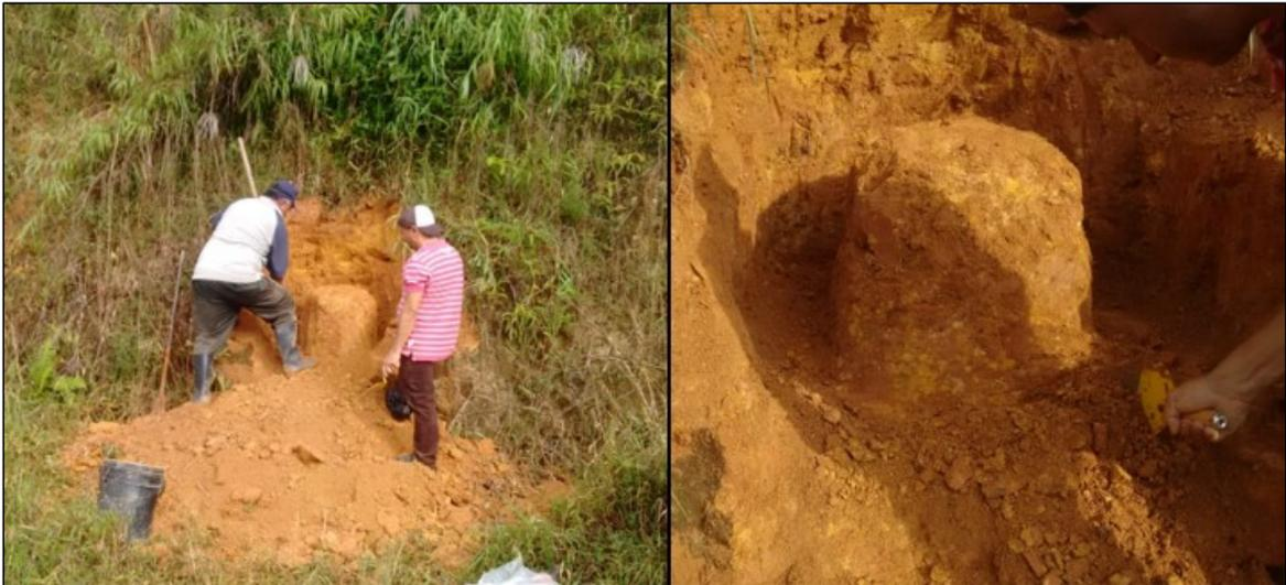
**Figura 5-1:** Extracción de la muestra en bloque, fecha 7 de Julio de 2018.
