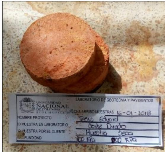
**Figura 5-15:** Muestra fallada con humedad natural por corte directo, modalidad CD.
