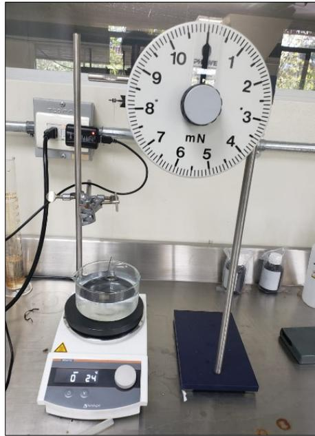
**Figura 5-5:** Tensiómetro de Du Nouy.
