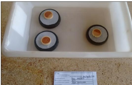
a) Saturación de la muestra agua destilada
