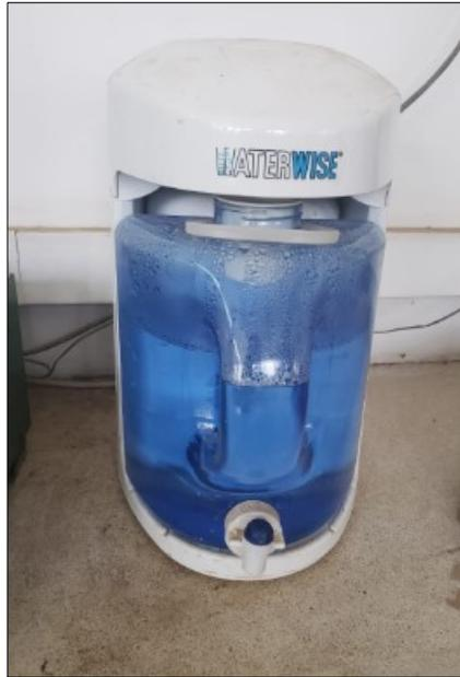
**Figura 5-3:** Destilador utilizado para el proceso de destilación del agua.
