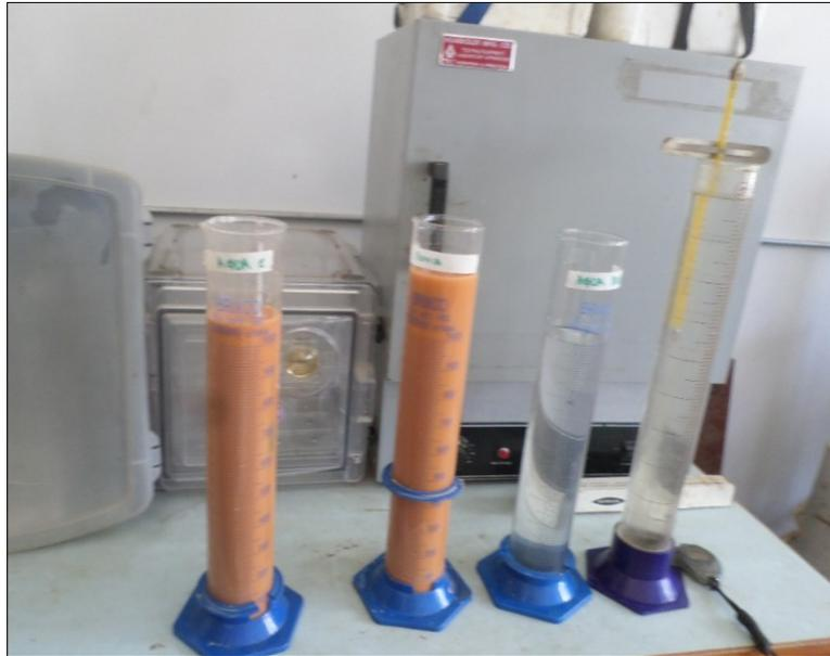
**Figura 5-8:** Granulometría por hidrómetro agua destilada y agua lluvia.
