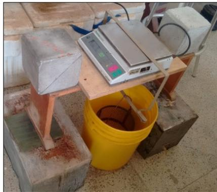
**Figura 5-22:** Montaje ensayo de balanza hidrostática.
