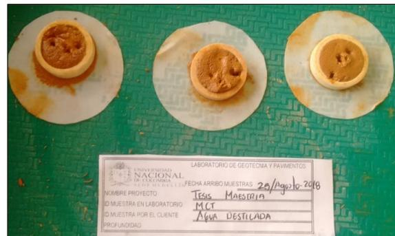
b) Prueba de penetración
