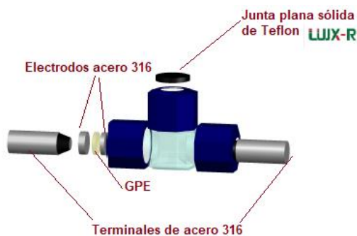
Figura 2-7. Diagrama esquemático de la celda para análisis de conductividad.
