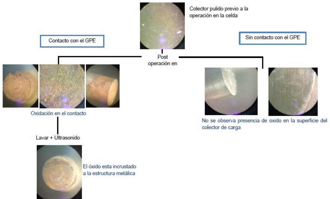
Esquema 4-1. Imágenes en el estereomicroscopio OLYMPUS para colector anódico. Mantuvo contacto con el líquido iónico o el GPE(Izquierda), sin contacto con agentes corrosivos (Derecha) Elaboración propia.
