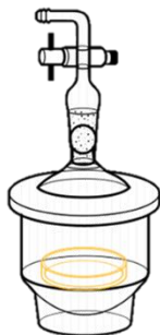
Figura 2-6. Montaje empleado para el secado de la membrana al vacío.
