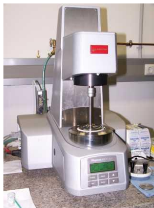
Figura 2-1: Equipos de medición. a) Reómetro Brookfield. b) Reómetro Anton Paar
