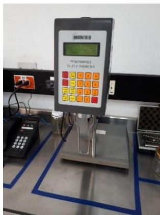
Figura 2-1: Equipos de medición. a) Reómetro Brookfield. b) Reómetro Anton Paar
