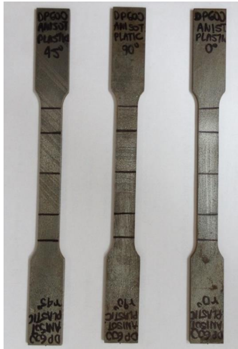
Figura 2- 6 Probetas anisotropía plástica para cada orientación
