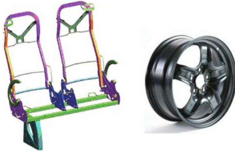
Figura 1- 9 Aplicación de aceros doble fase en estructura de asientos y rines (Gomes et al., 2005)
