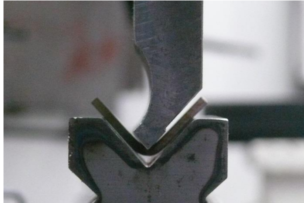
Figura 2- 7 Ensayo de doblado V
