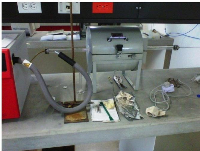
Figura 11. Montaje experimental utilizado para la síntesis de BCNTs.
