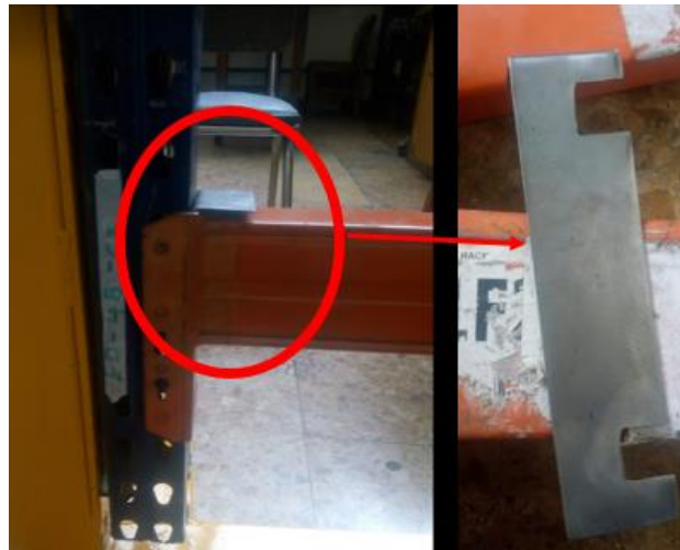
Figura 2-5 Lámina separador viga columna.
