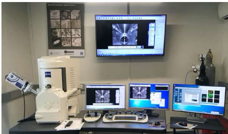
Figura 4-23: SEM Carl Zeiss EVO MA 10 - EDS Oxford X-act PentaFet® Precision.
