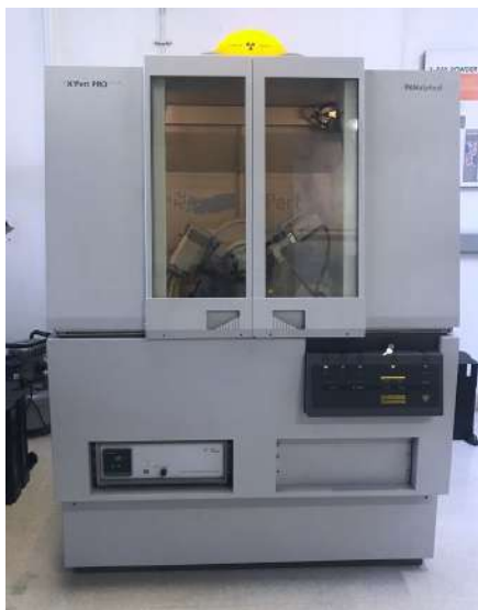
Figura 4-25: Difractómetro PANalytical Xpert Pro MPD.
