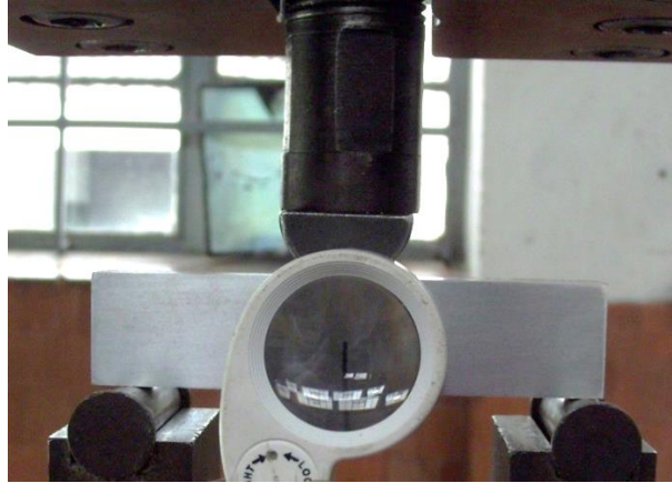
Figura 2-10. Monitoreo del crecimiento de grieta
