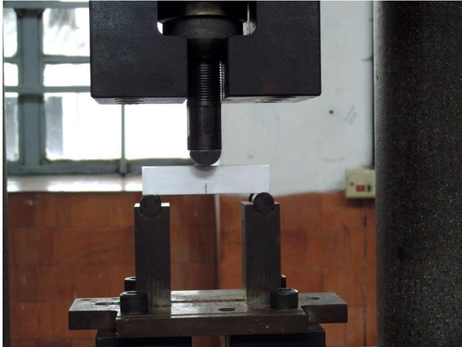
Figura 2-8. Montaje de la probeta para pre-agrietamiento por fatiga
