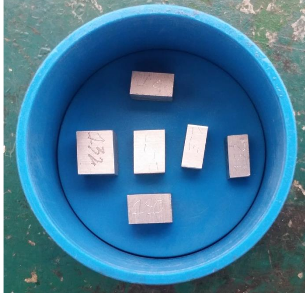
Figura 2-36. Disposición de las probetas seccionadas en el molde en frío para obtener la pastilla de montaje para realizar posterior preparación para análisis metalográfico
