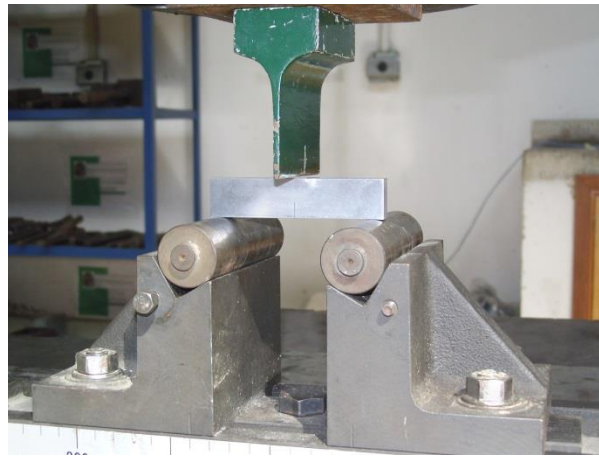
Figura 2-11. Montaje flexión en tres puntos, máquina universal de ensayos
