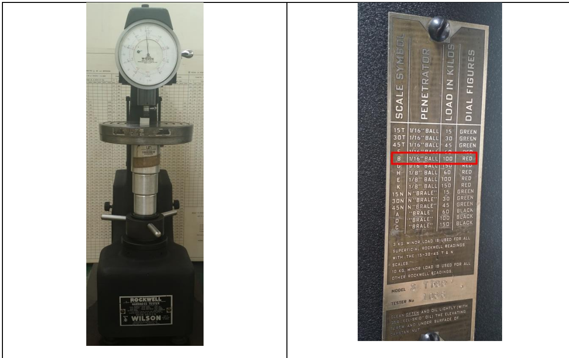
Figura 2-21. Durómetro, escala y carga utilizados para medida de dureza
