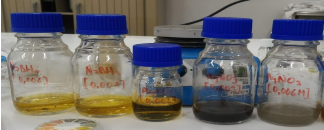
Figura 1: Nanopartículas de plata formadas a partir de \text{NaBH}_4 y \text{AgNO}_3 con concentraciones de 0.006 M-0.001 M; 0.004 M-0.001 M; 0.002 M-0.001 M; 0.002 M-0.003 M; 0.002 M-0.006 M; respectivamente
