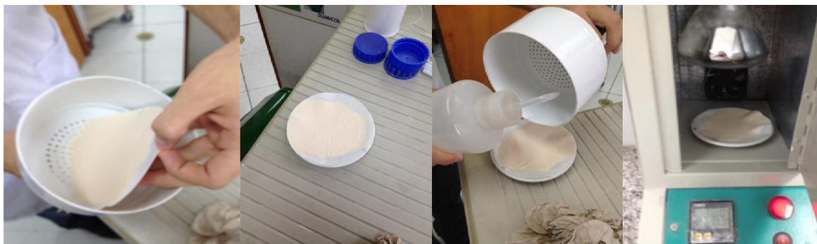
Fig. 14. Recuperado torta de filtrado. Prueba de reactividad (SUMICOL. S.A)
