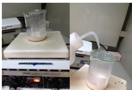
Fig. 10. Montaje agitador térmico. Prueba de reactividad (SUMICOL. S.A)
