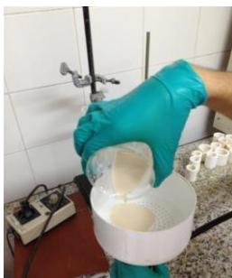
Fig. 11. Filtración al Vacío. Prueba de reactividad (SUMICOL. S.A)
