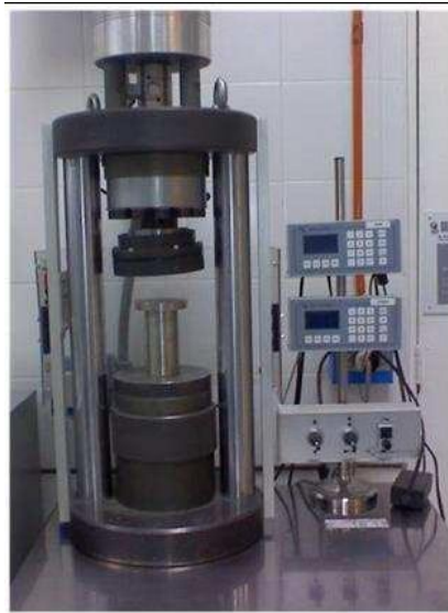
Fig. 22. Equipo de compresión (SUMICOL S.A)
