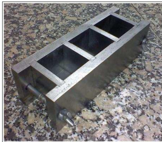
Fig. 21. Molde para cubos de 50 x 50 mm. (SUMICOL S.A)
