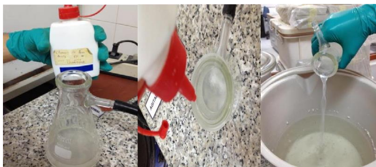
Fig. 13. Montaje lavado. Prueba de reactividad (SUMICOL. S.A)
