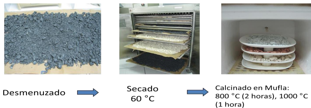
Fig. 15 Metodología de activación térmica de arcillas para validar como materia prima para pinturas.
