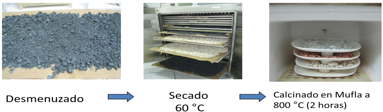
Fig. 16. Metodología de activación térmica de arcillas para validar como materia prima para pasta de revestimiento cerámico.
