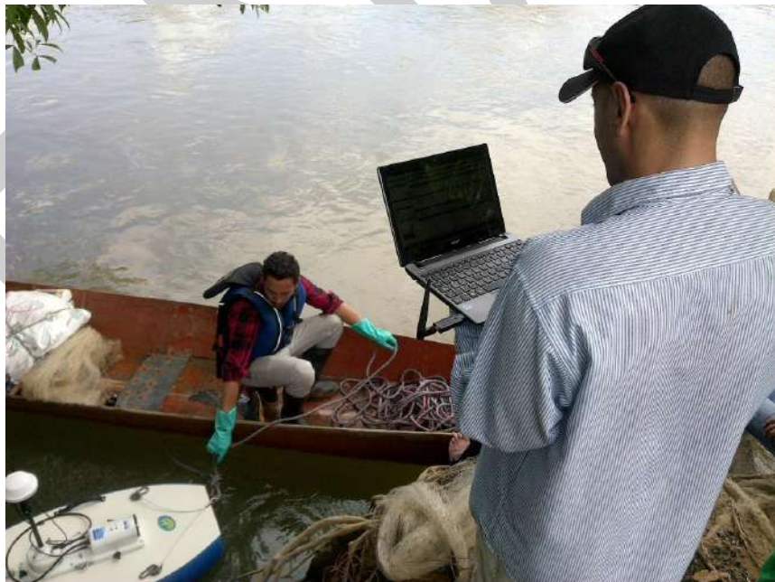
Figura 19. Aforo en el río Hacha a la Altura de Capitolio empleando lancha a motor; equipo asegurado al bote mediante cuerda.
