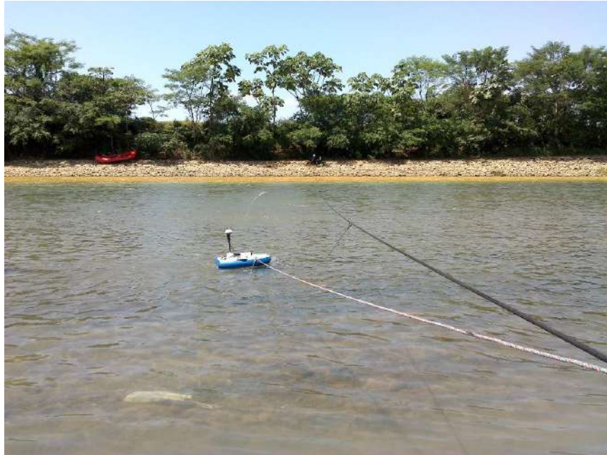
Figura 18. Aforo sobre el río Hacha aguas abajo de la confluencia quebradas El Dedo y La Yuca; equipo de medición asegurado mediante línea de vida.
