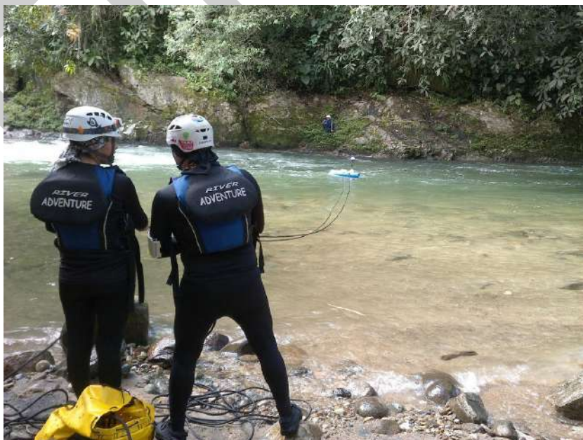
Figura 15. Medición de caudal con perfilador acústico ADCP aguas abajo del puente vehicular de la bocatoma El Diviso; equipo de medición maniobrado desde las riberas del río mediante un aparejo de cuerda doble tipo polea.
