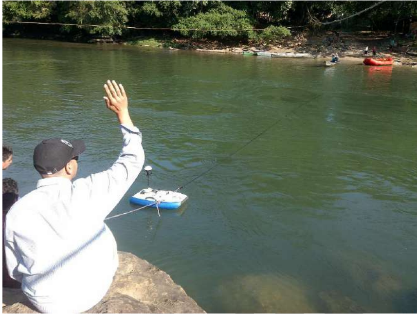
Figura 16. Instalación de cuerdas perpendiculares de maniobra del equipo empleando bote a remo, para medición de caudal en el río Hacha a la altura de La Bronca.
