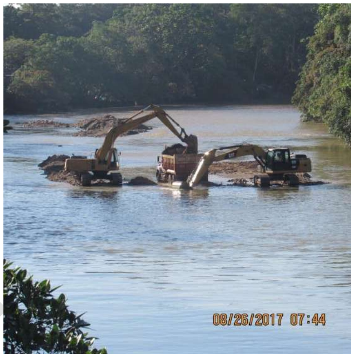
Figura 175. Extracción de material de arrastre en el sector de Puente López de Florencia (Fuente: este estudio, 2017)
