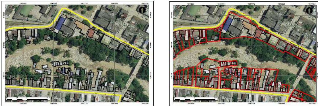
Figura 55. Ajuste de fotorrestitución a). Fotorrestitución inicial b). Fotorrestitución posterior a reconocimiento en campo. Fuente: Ortofoto Geospatial 2017
