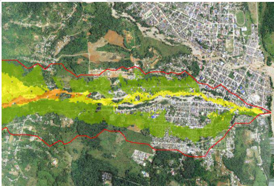
Figura 179 Propagación de la avenida fluvio-torrencial (Baja Probabilidad)
