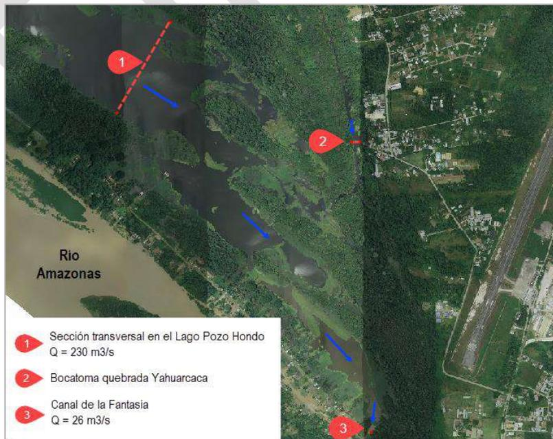
Figura 108. Mediciones de caudal en la zona inundable; las flechas azules indican la dirección del flujo del agua, los puntos rojos la localización de las secciones transversales aforadas
