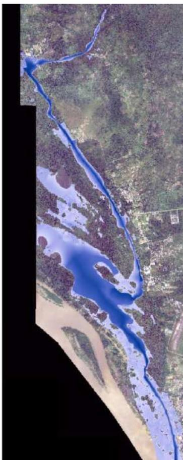
**Figura 137** Inundación de T=2 años de la quebrada y el sistema lagunar de Yahuaraca. Fuente: Equipo Rondas Hídricas.
