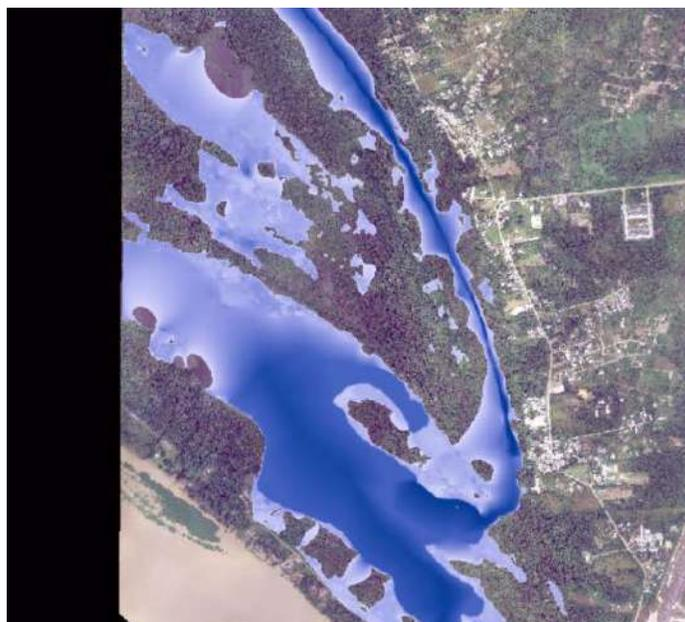
**Figura 141** Inundación de T=5 años del Sistema Lagunar de Yahuarcaca. Fuente: Equipo Rondas Hídricas
