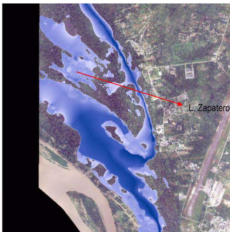
**Figura 144** Inundación de T=10 años del Sistema Lagunar de Yahuaraca. Fuente: Equipo Rondas Hídricas.
