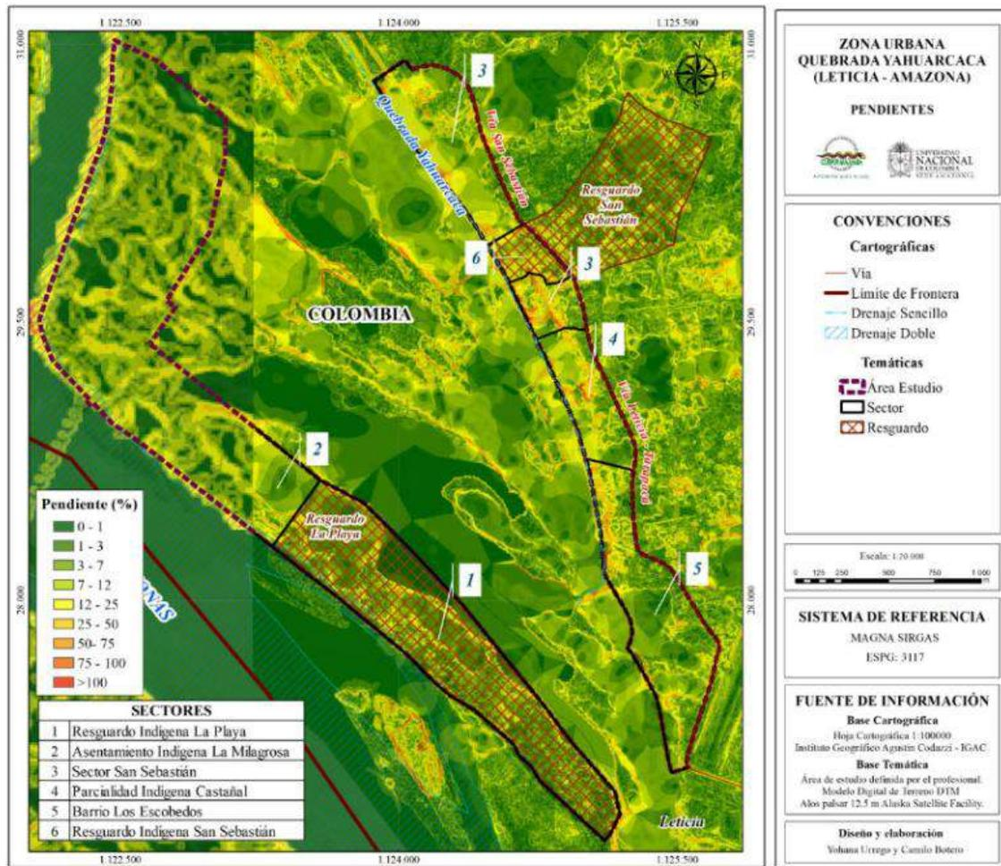
**Figura 195.** Pendientes en el área de estudio predial. Fuente: DTM Geospacial 1m resolución espacial abril 2017, DEM ALOS PALSAR 12,5m resolución espacial 2010 y trabajo de campo.
