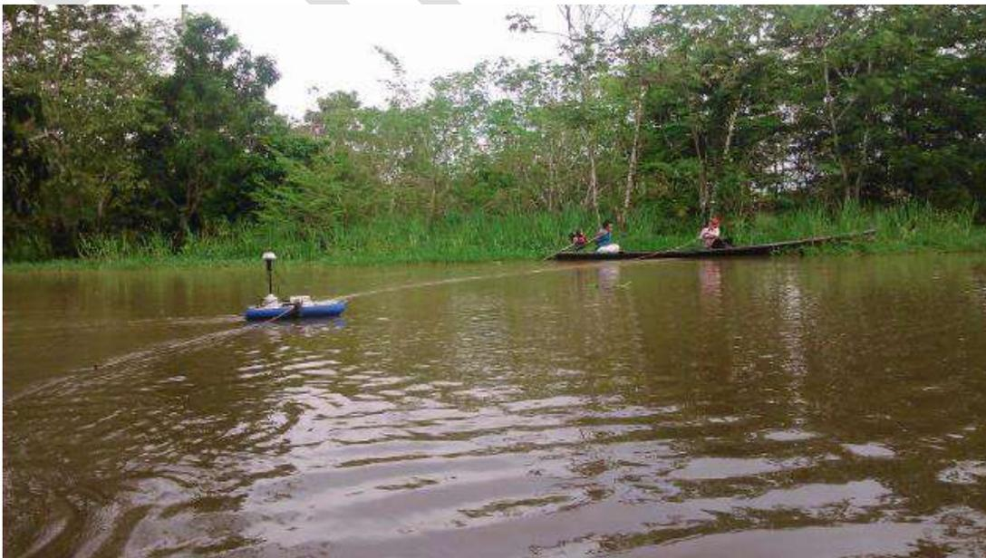
**Figura 23.** Aforo con perfilador acústico desde dos embarcaciones en la quebrada Yahuarcaca
