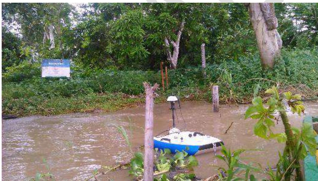
**Figura 21.** Perfilador acústico de efecto Doppler marca SonTek.
