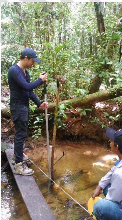
**Figura 24.** Micromolinete *Water Global*.
