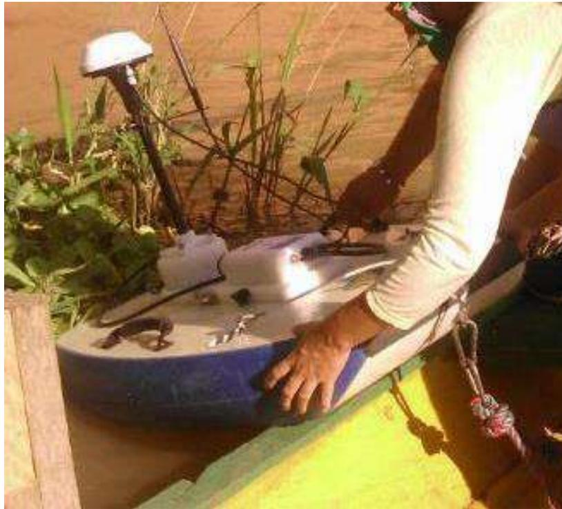
**Figura 22.** Perfilador acústico ADCP asegurado con cuerda al arnés para su manipulación desde la embarcación
