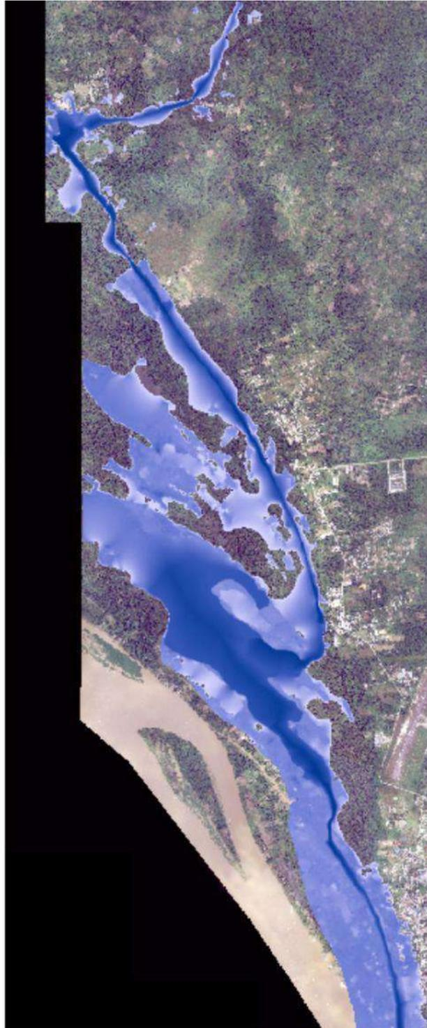
**Figura 150** Inundación de T=100 años del sistema lagunar de Yahuarcaca y quebrada Yahuarcaca.
