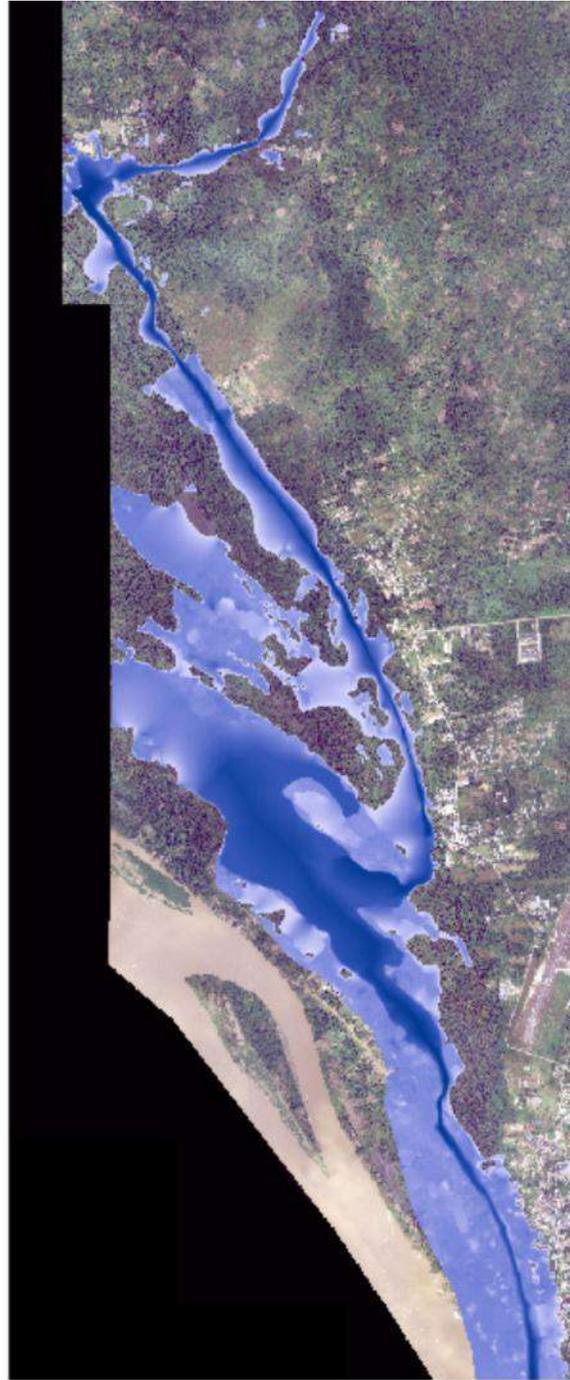
**Figura 148** Inundación T=50 años del sistema lagunar de Yahuaraca y quebrada Yahuaraca.
