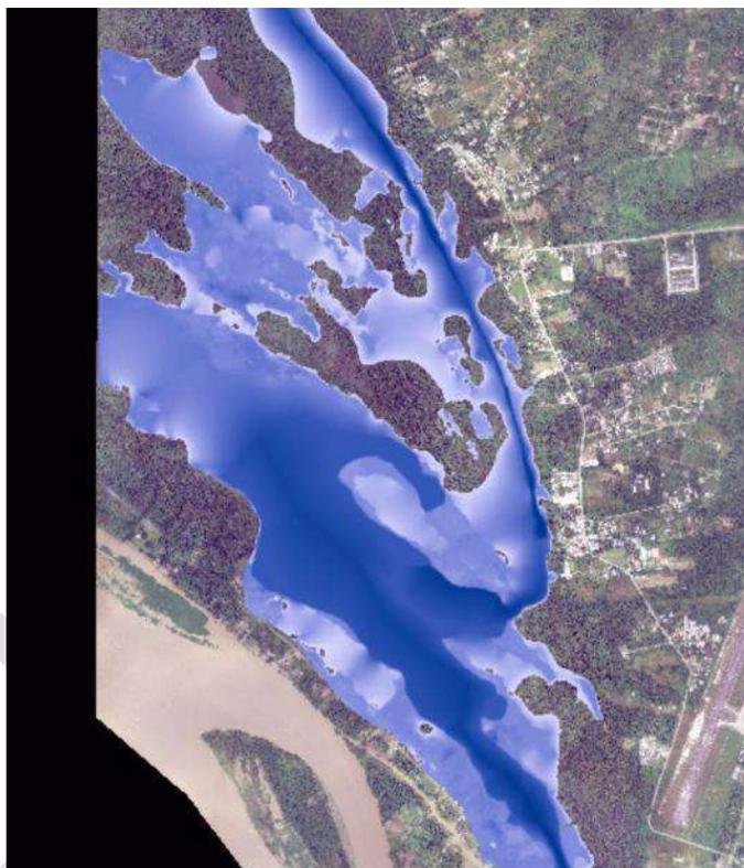
**Figura 149** Inundación de T=100 años del sistema lagunar de Yahuaraca y quebrada Yahuaraca.
