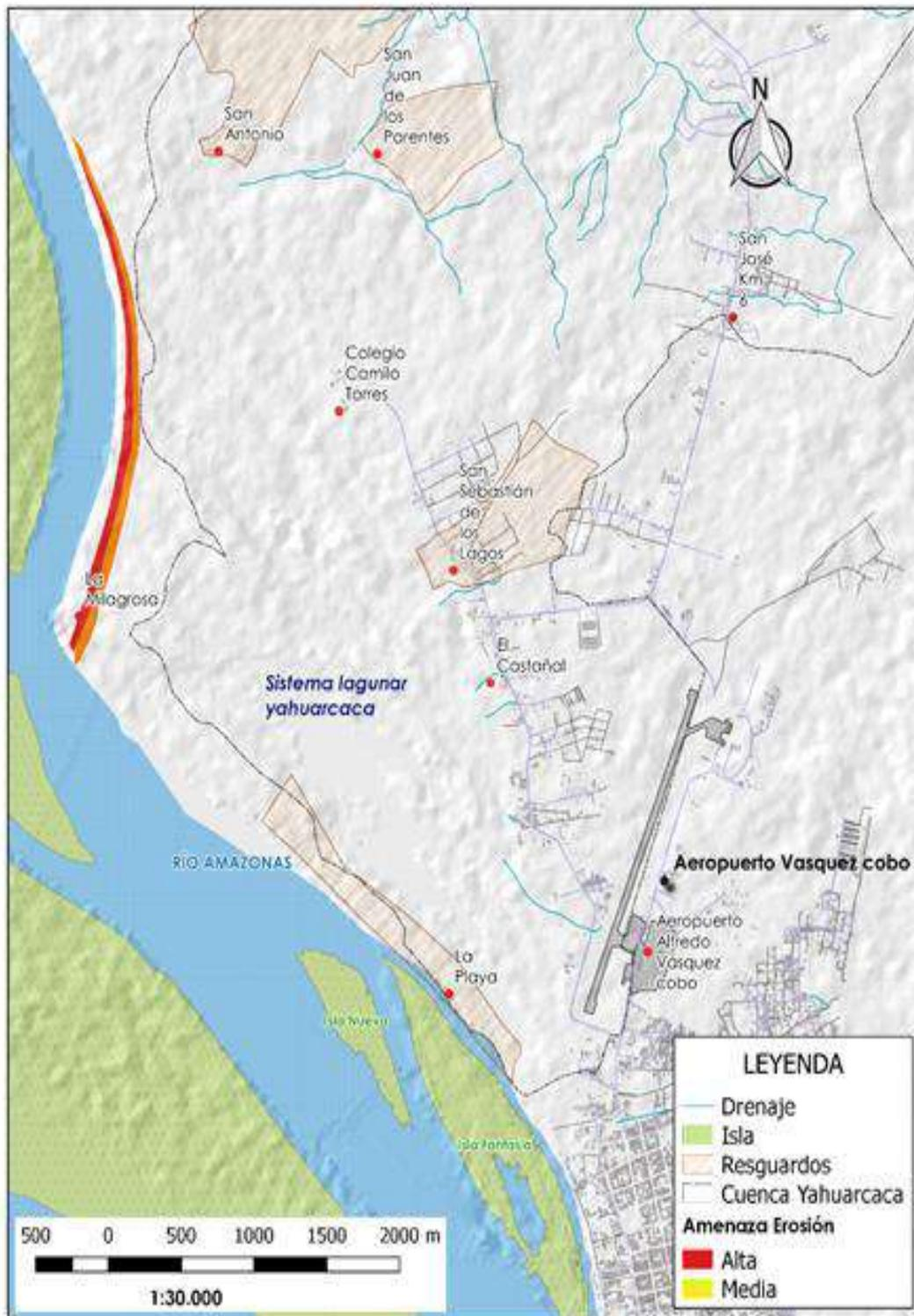
Figura 250. Amenaza por erosión y socavación del Canal de Ronda (Leticia, Amazonas).
