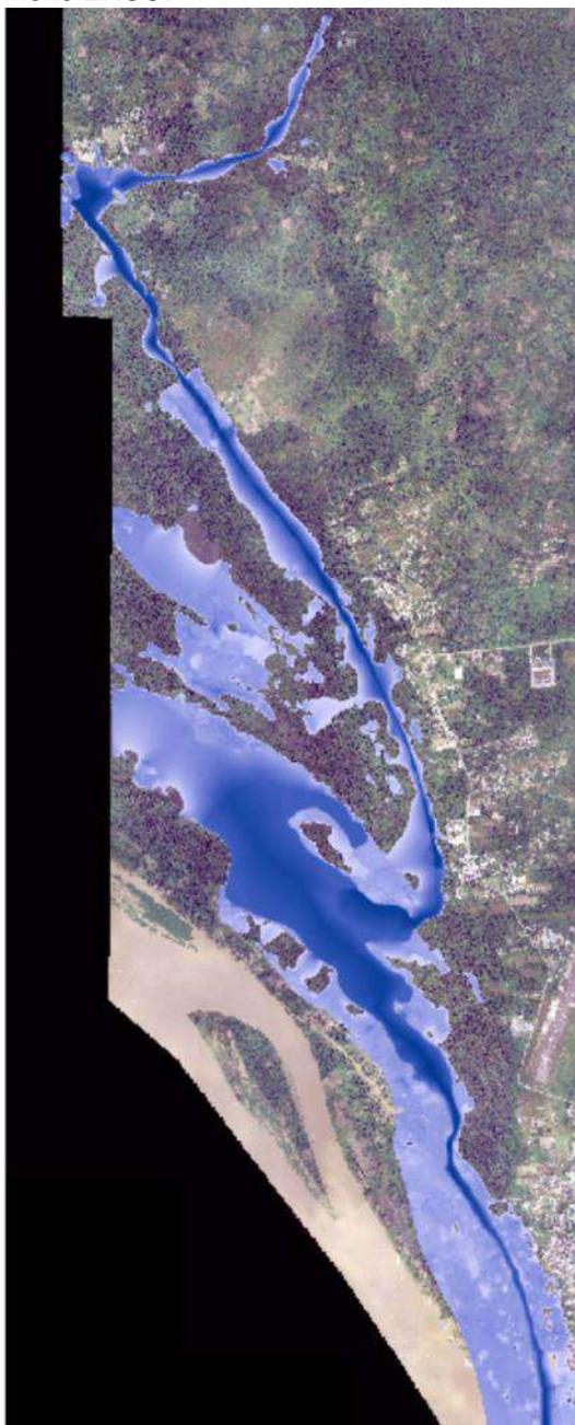
**Figura 143** Inundación de T=10 años de la quebrada Yahuaraca. Fuente: Equipo Rondas Hídricas.
