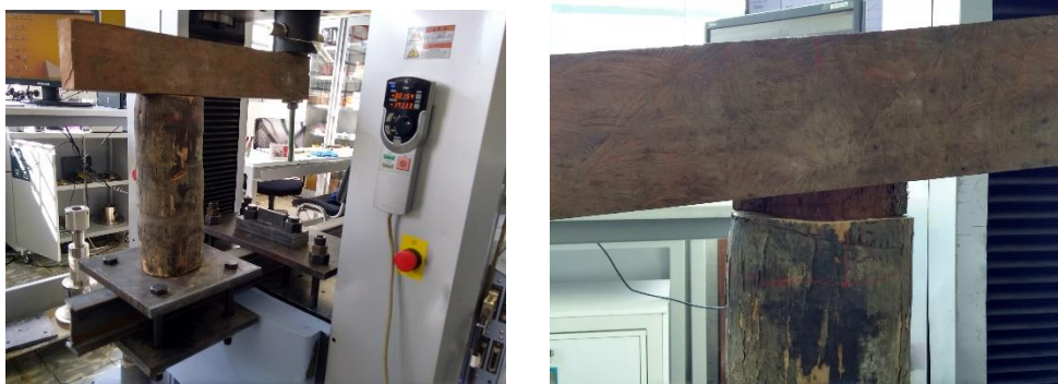
Figura 4-41. Rotación de la unión ensayo monotónico positivo - unión a momento.
