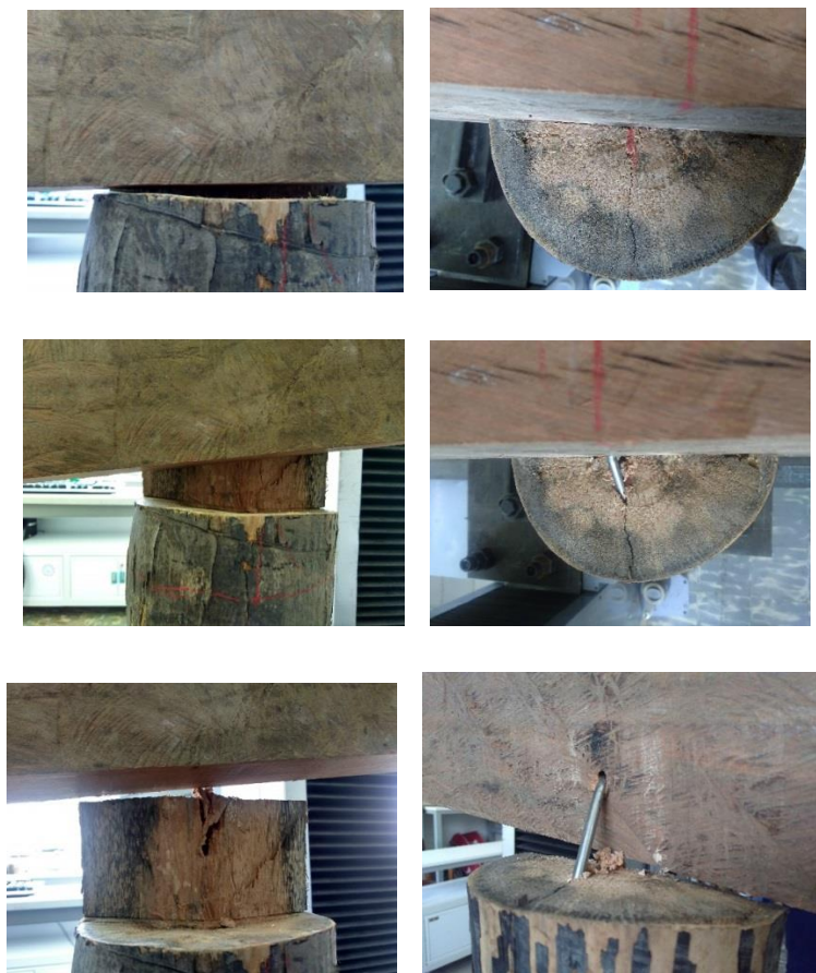
Figura 4-39. Ensayo monotónico positivo – unión a momento
