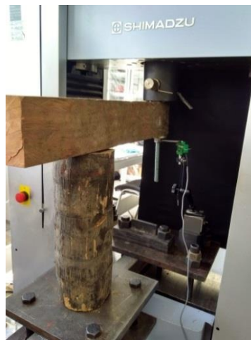
Figura 3-12. Instrumentación ensayo unión a momento
