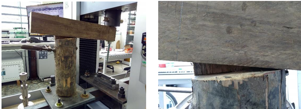
Figura 4-42. Rotación de la unión ensayo monotónico negativo - unión a momento.
