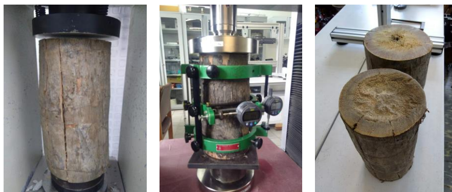
Figura 4-32. Montaje experimental relación de Poisson Attalea colenda
