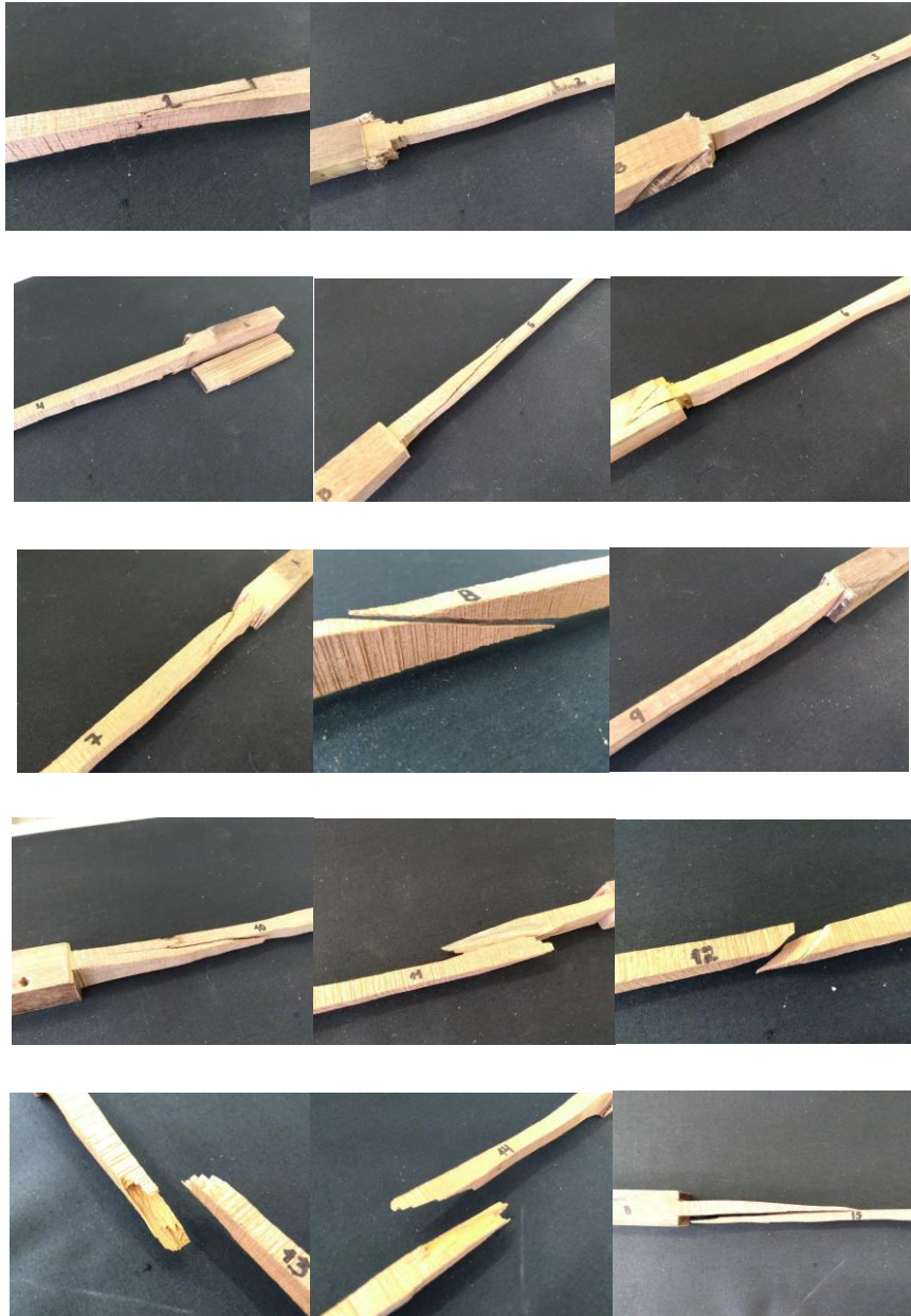
Figura 4-18. Fallas presentadas en ensayo de tensión Goupia glabra
