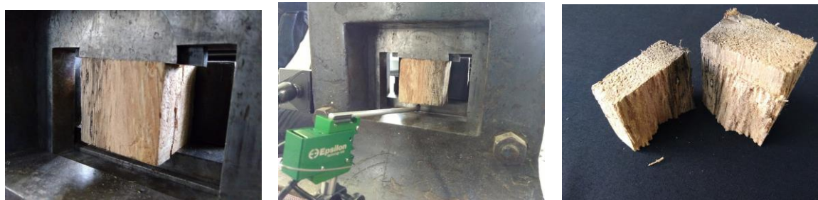
Figura 4-35. Aplicación de la carga (a), registro de la deflexión (b), falla típica (c)
