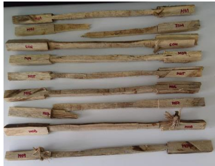
Figura 4-33. Probetas de tensión paralela al grano Attalea colenda
