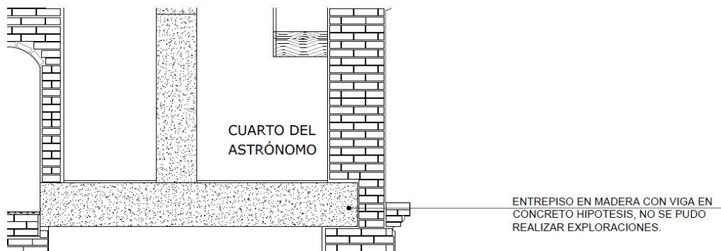
Figura 162. Entrepiso en concreto.
