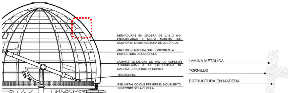
Figura 166. Detalle estructura de cúpula
