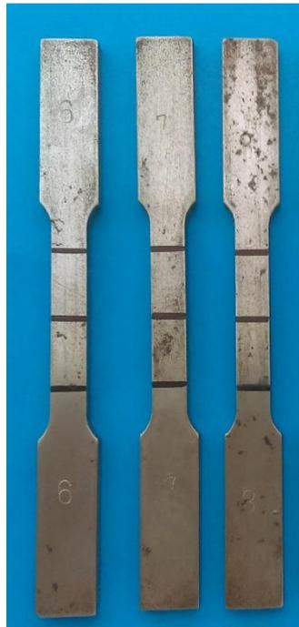
Figura 2-9 Probetas en estado de entrega
