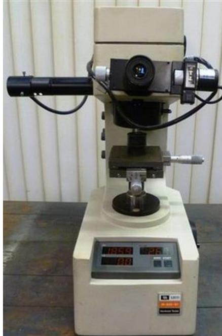
Figura 2-5 Microdurómetro LECO M400-G2
