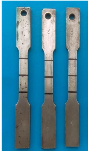
Figura 2-8 Probetas Tratadas térmicamente.
