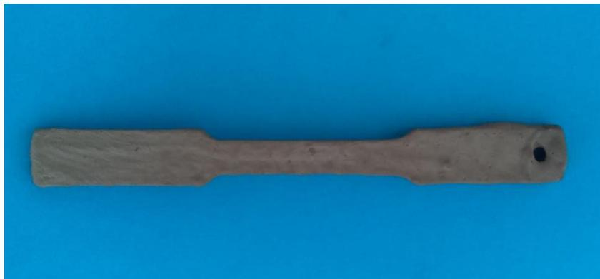
Figura 2-2 Probeta con recubrimiento antes de realizar el tratamiento térmico
