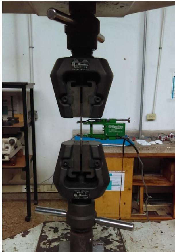
Figura 2-6 Montaje del ensayo de tensión.
