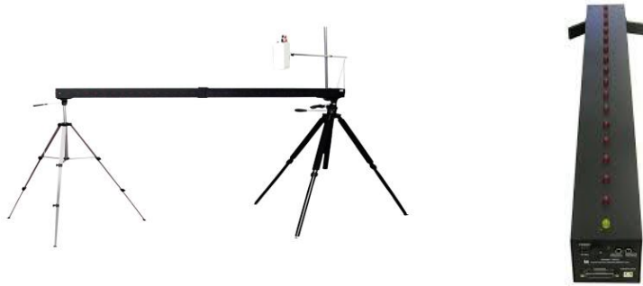
Figura 5-6: Montaje para la prueba de anticipación y tiempo de respuesta. (elaboración propia)
