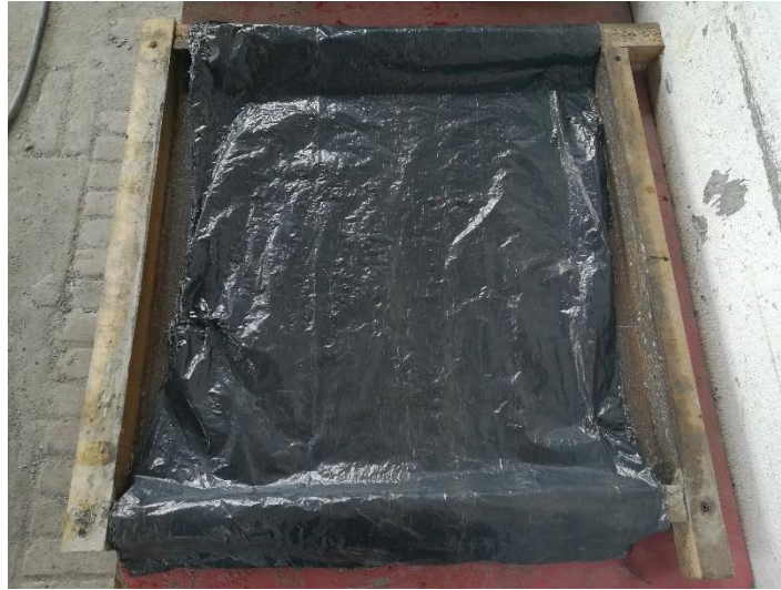
Fotografía 6- Preparación de un molde
