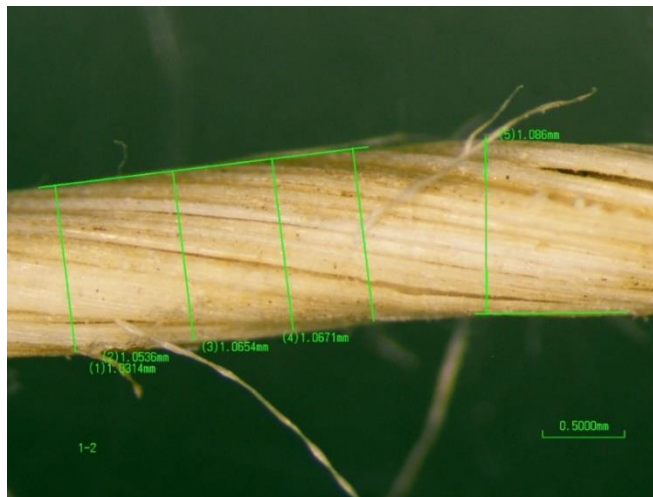
Fotografía 3- Detalle de una fibra de fique multifilamentos
