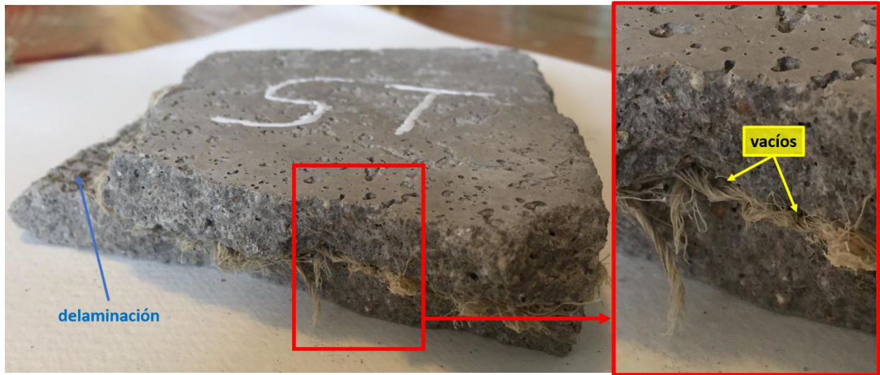
Figura 17- Fotografías de la interfaz del material compuesto mortero - fibras no tratadas
