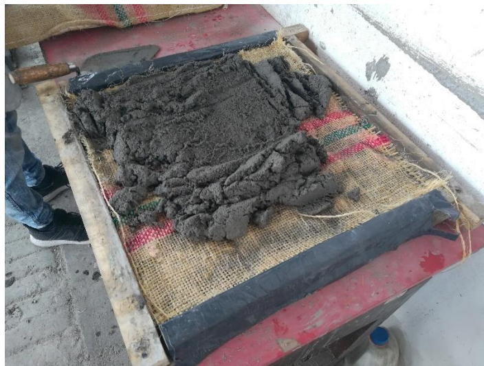
Fotografía 7- Fundición de una lámina
