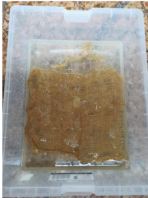
Fotografía 4- Proceso de alcalinización de un tejido
