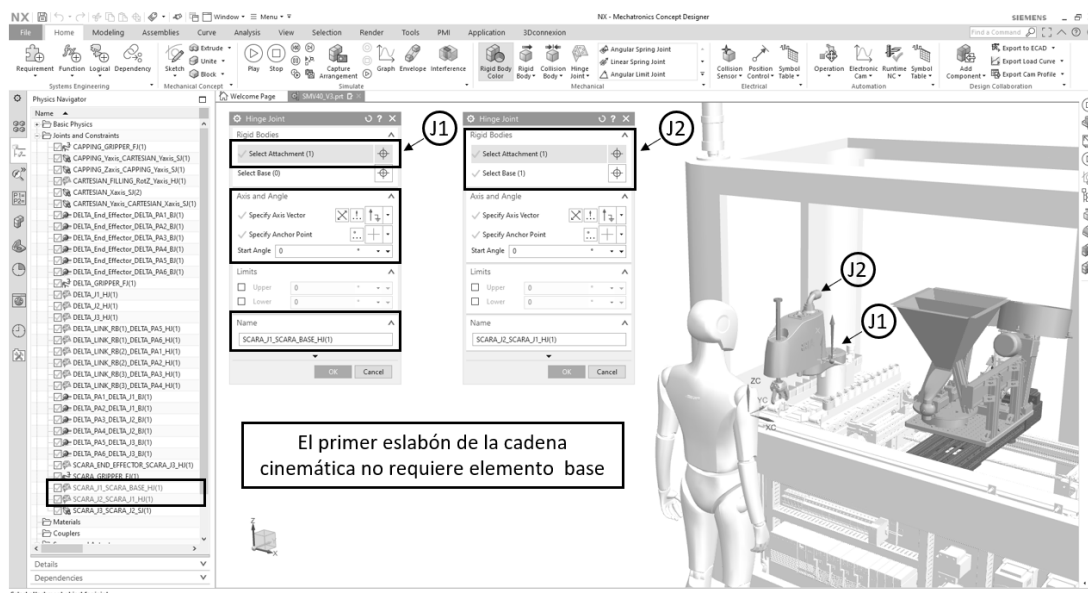
Figura 3.7: Configuración de uniones en cadenas cinemáticas.[Autor]
