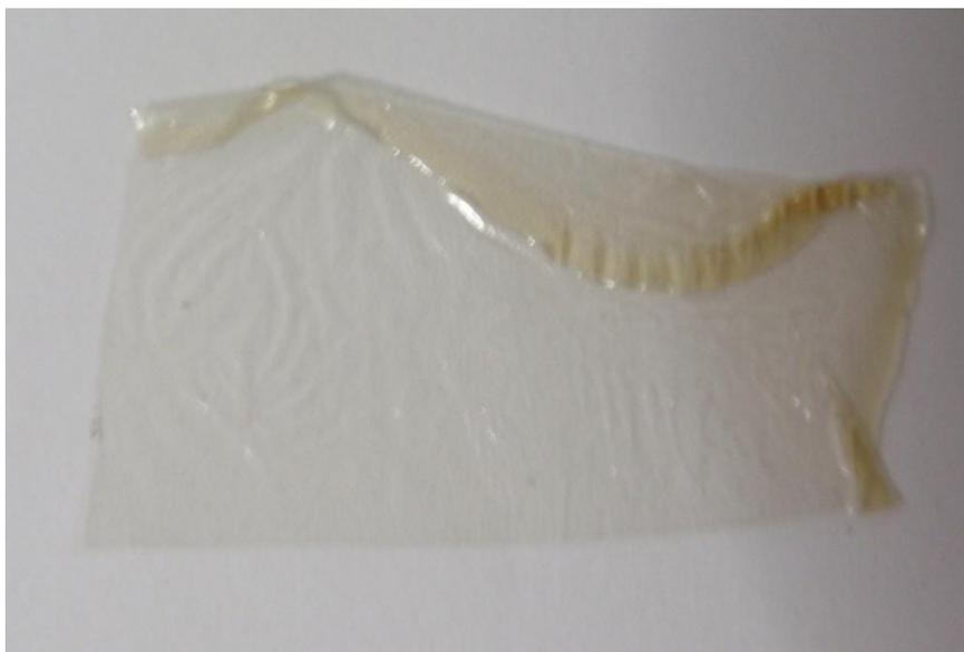
Figura 2. Película de quitosano obtenida en casting sobre placa de teflón
