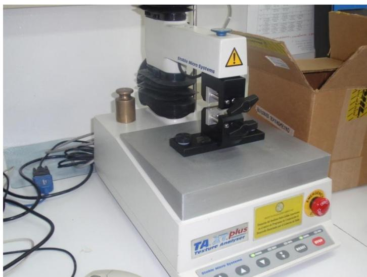
Figura 4. Texturometro digital TA XT plus, en prueba a película de quitosano.
