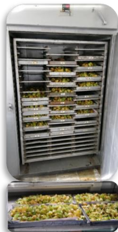
Figura 5 Secado en Horno
